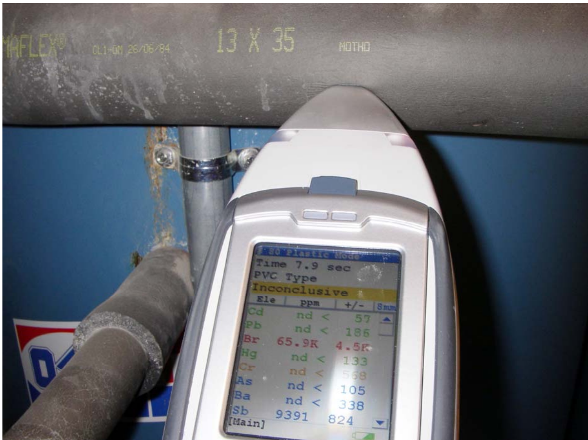
Figur 4: XRF-måling av cellegummi. Merk utslaget på Br på 65 900 mg/kg.
