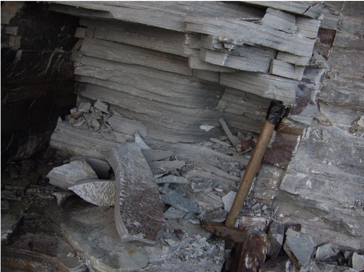
Figur 15 b: Nærbilde av bruddflate i Fossheimbruddet (lokalitet er sentralt i Figur 13 a). Bildet viser god spaltbarhet og finskala laminering mellom mørkere og lysere lag.
