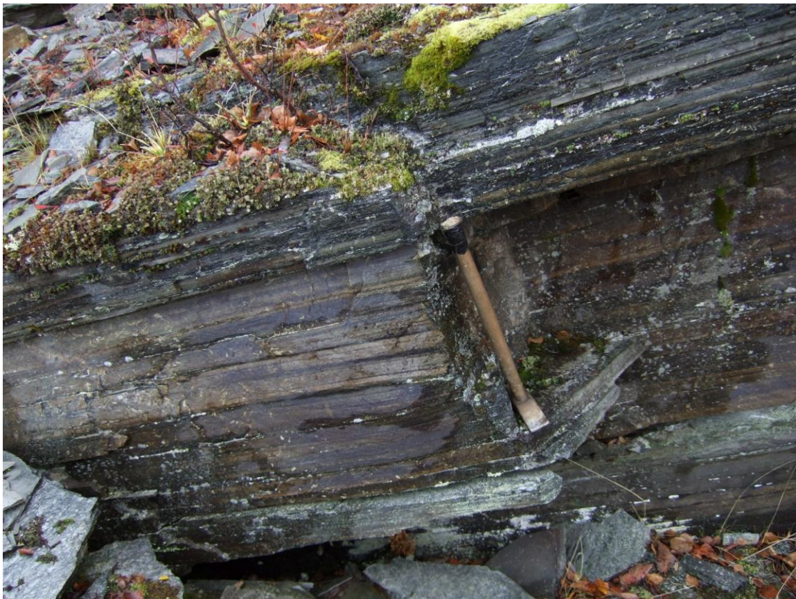
Figur 22 b: Nærbilde av bruddkant i hovedbruddet i Kroken som viser den utpregede planskiffrigheten og cm-skala laminering.
