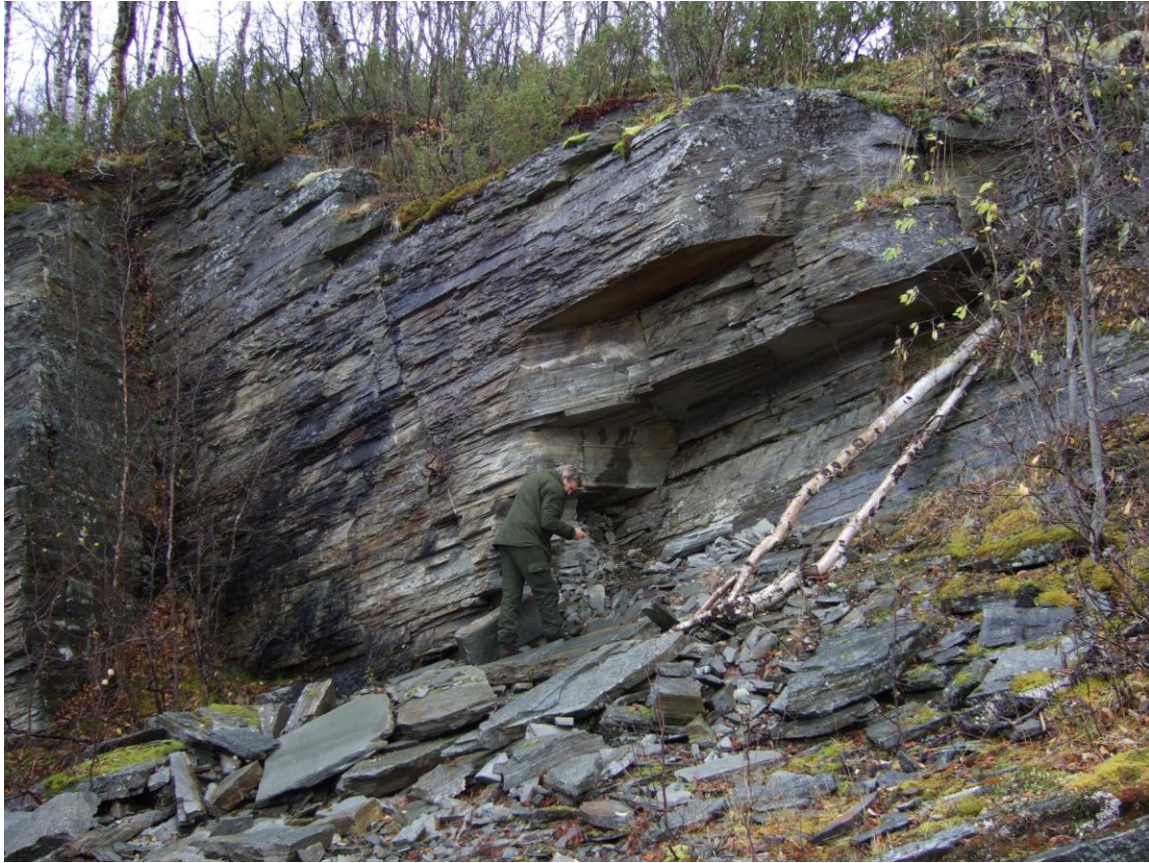
Figur 22 a: Bruddkanten i hovedbruddet i Kroken som viser den utpregede planskiffrigheten og høyden på den gode sonen.
