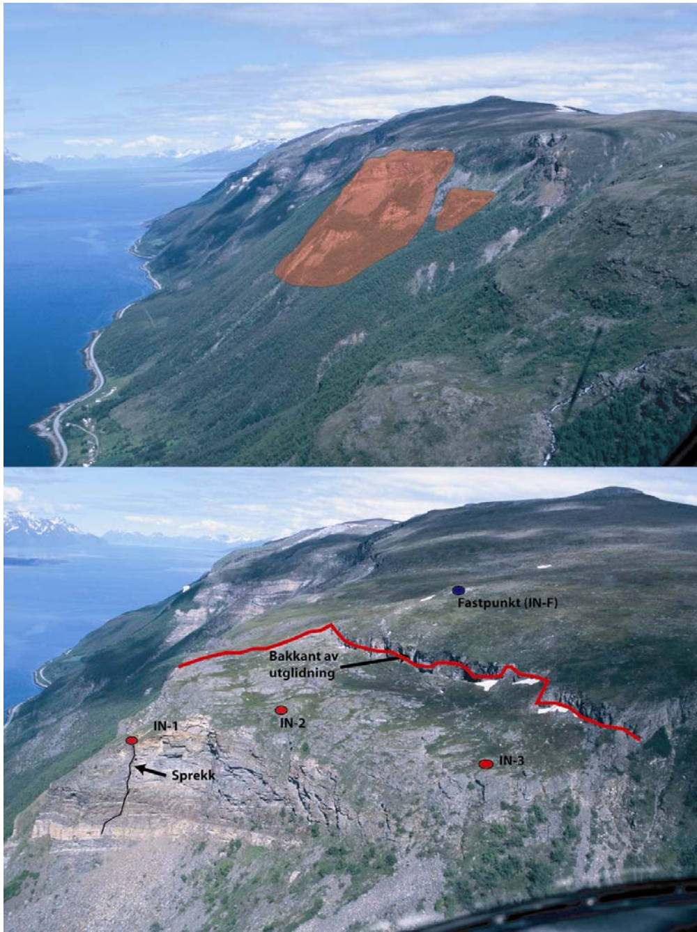
Figur 4. Oversikt over det ustabile fjellpartiet ved Indre Nordnes. Lokalisering av GPS punktene er vist.
