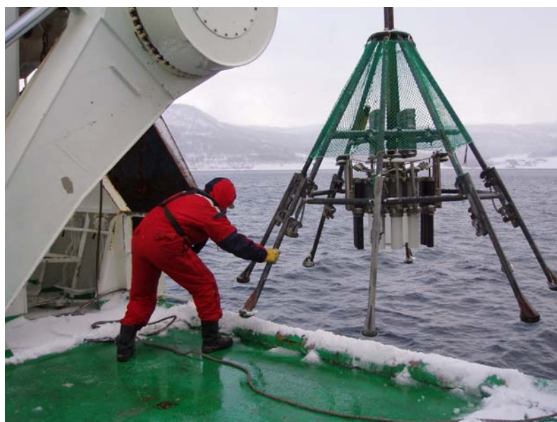
Figur 3. Multicoreren på vei ut klar for prøvetaking fra akterdekket av F/F G.O. Sars. Bildet er fra prøvetaking i Rotsundet.
