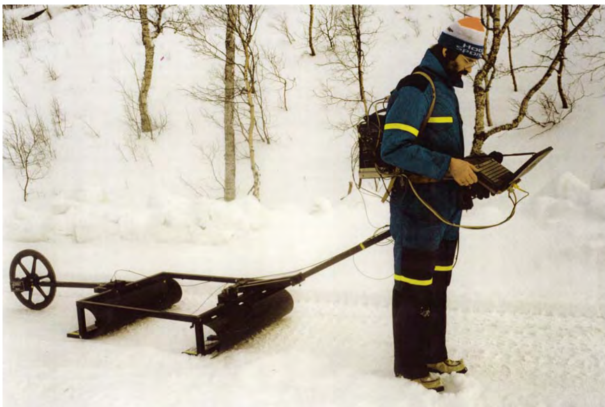
Figur 1: Georadar under måling. Bakerst et odometerhjul som trigger målingene ved forhåndsinnstilte intervall. På sleden sender og mottaker med tilhørende antenner, her med senterfrekvens 100 MHz. Bak på ryggen et konsoll som administrerer måleprosessen, og foran en PC som styrer målingene, viser måledata og lagrer måledata på fil.
