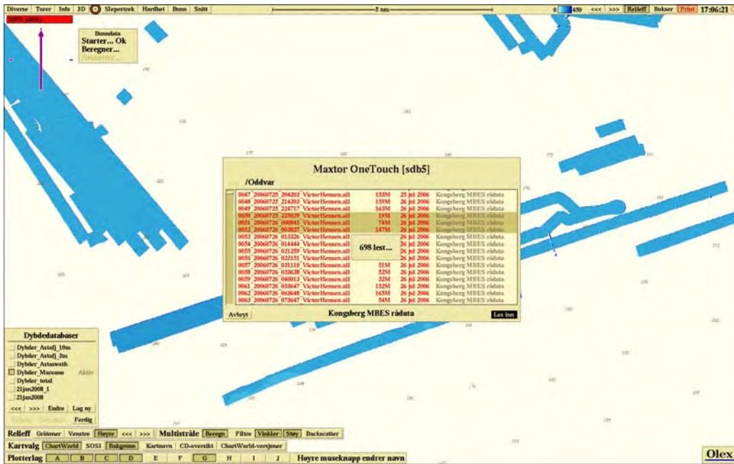
Figur 1 . Skjerm bilde som viser innlesning av rådata til Olex. I nedre venstre hjørne vises kommandoboksen med flere forskjellige databaser. Databasene kan opprettes og navngis av brukeren, og med et tastetrykk kan man skifte mellom de ulike dybdedataene som vises på skjermen. Databasen som er valgt - Dybder_Mareano - er satt som aktiv. Det betyr at data som leses, går inn i den databasen.
