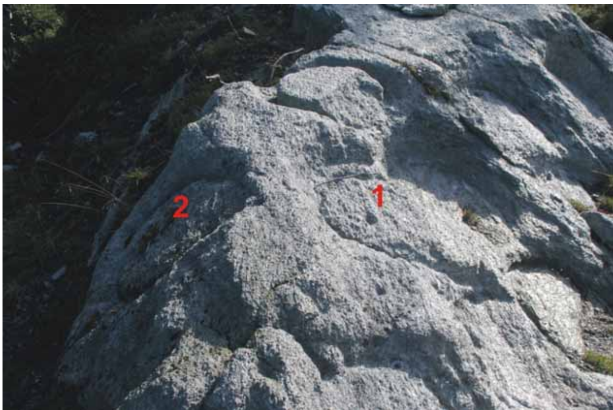
Figur 3-6. Uttak av kvernstein i to retninger: 1) splittet på hovedkløv, 2) splittet på sekundærkløv
