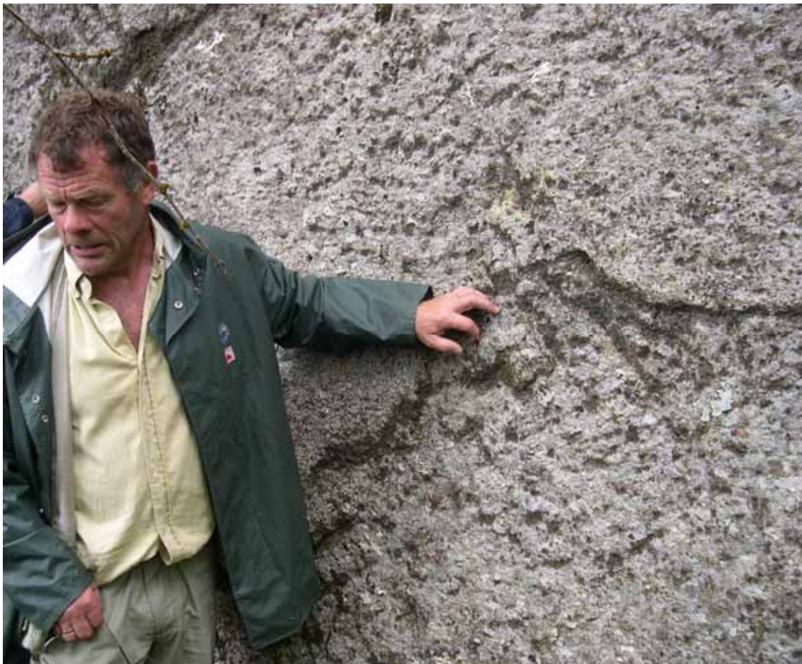
Figur 3-2. Vegg som markerer avslutning av et brudd. Driften stoppet da man kom ned til lag med altfor store granater.
