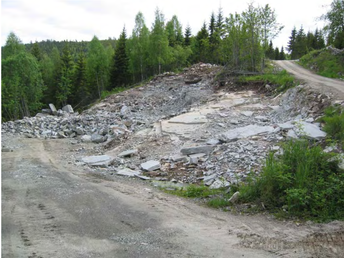
Figur 4: Østligste del av Grasbottbruddet sett mot vest. I den nærmeste delen tas det ut større plater, mens det i området i bakgrunnen produseres hovedsaklig murestein.
