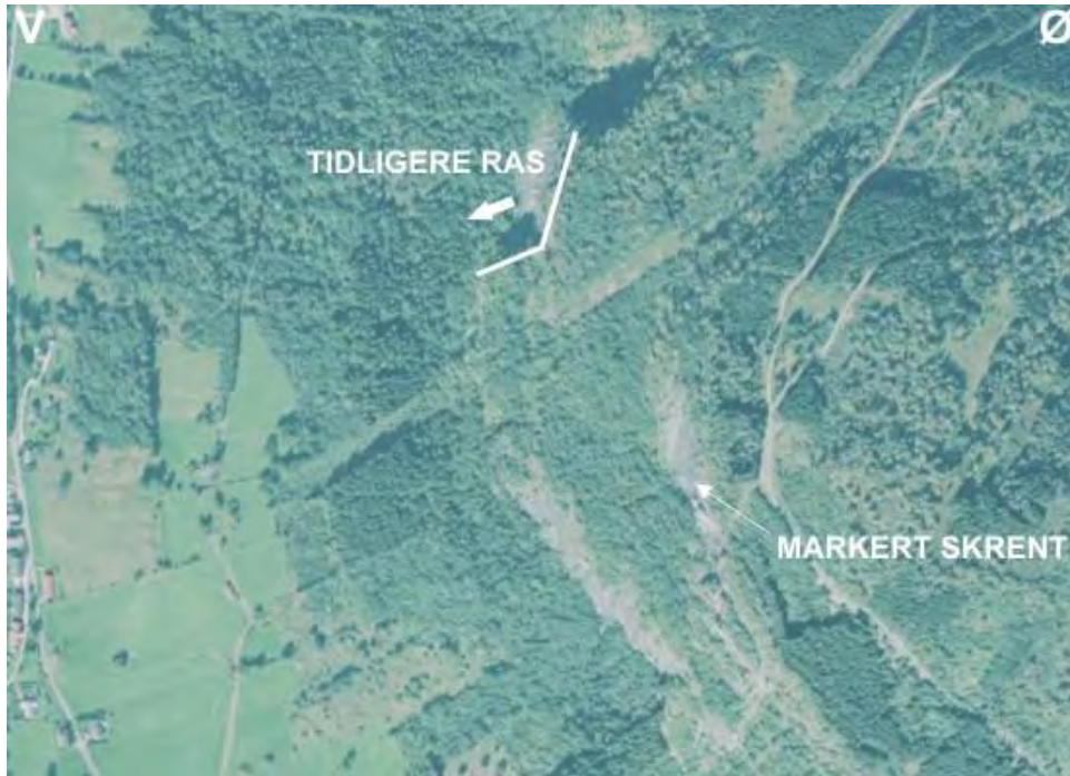
Figur 33: Ortofoto over Vik som viser den nordligste delen hvor det har gått et gammelt ras, og den sørligste delen hvor det er en markert skrent.
