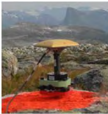
Figur 11: Eksempel på en GPS antenna montert på en trefot. Trefoten er montert på en bolt som er boret og limt fast i fjellet.
