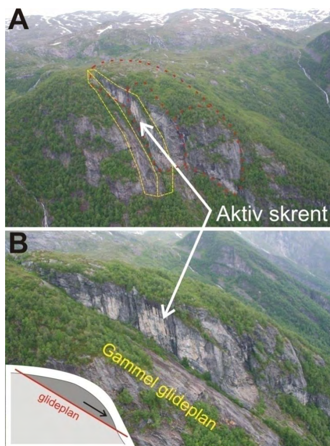
Figur 84: Vestsiden av Lånefjorden. A- Lokalitet 36a sett mot vest som viser et stort gjenværende volum som ligger over et mulig glideplan. Den gule linjen viser hvor et gammelt ras har gått på det samme glideplanet. De røde linjer avgrenser den mulig ustabile skråningen som ligger over glideplanet og noen mulige oppdelingsblokker. B- Skisse som viser utsikten av skråningen mot nord med det eksisterende glideplanet og volumet som ligger over dette.
