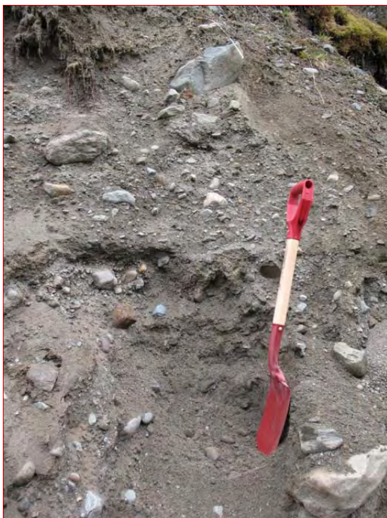
Figur 8: Snitt i steinig, grusig sand på kote 72 (eksponert i skjæring mot ravine øst, like ved traktorvegen). Materialet kan stedvis ligne på morene, hvilket skyldes at isbreen beveget seg og "knadde" massene under avsetningsfasen.
