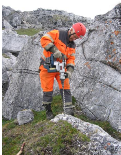
På grunn av vanskelige forhold måtte en benytte boreutstyr for etablering av geofoner og skuddpunkt.
