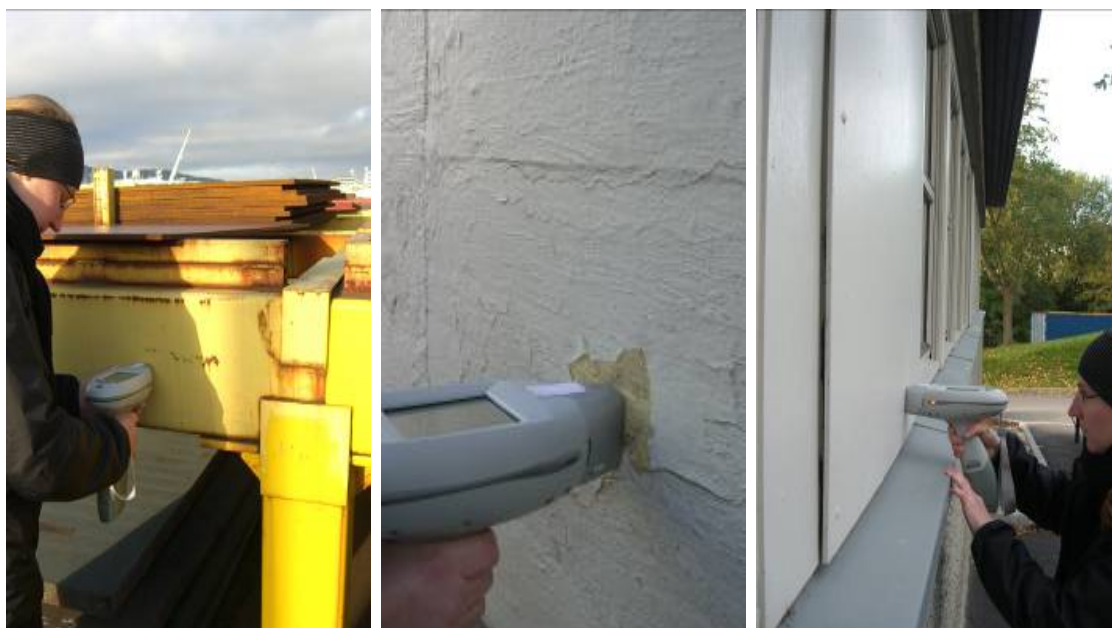
Figur 20 Kjemisk undersøkelse av husfasader med bærbar XRF på gamle og nye bygg.
