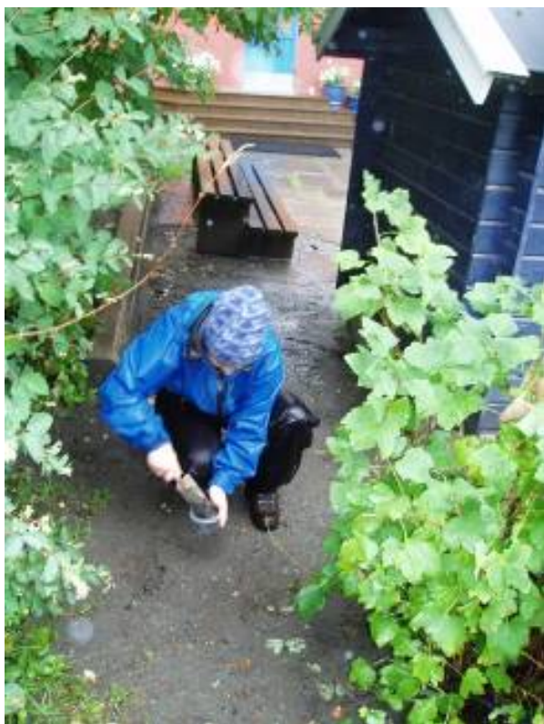
Figur 4.5.1 Lokalitet for prøvepunkt (4.8) byjord med høyt innhold av bly (190 mg/kg). I bakgrunnen er benken der det ble påvist CCA.
