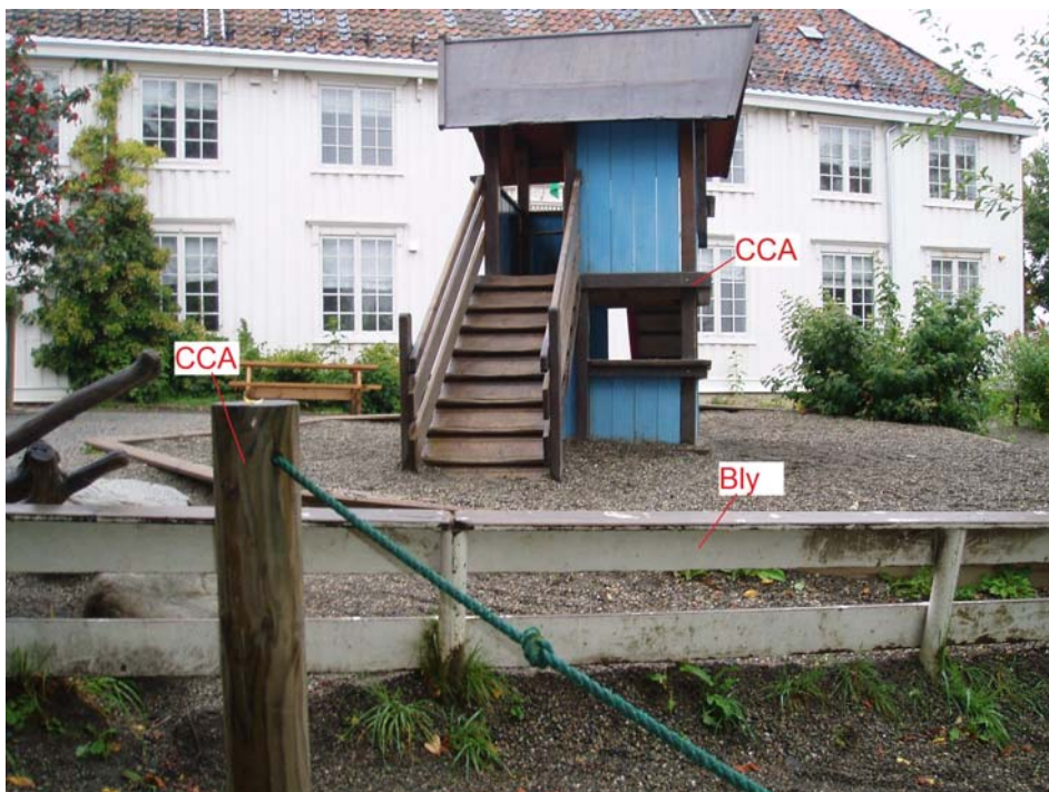
Figur 4.10.2 Lokalitet for prøvepunkt (9.9) med høyt innhold av bly (265 mg/kg). I tillegg vises trevirke med CCA og hvit maling med bly.
