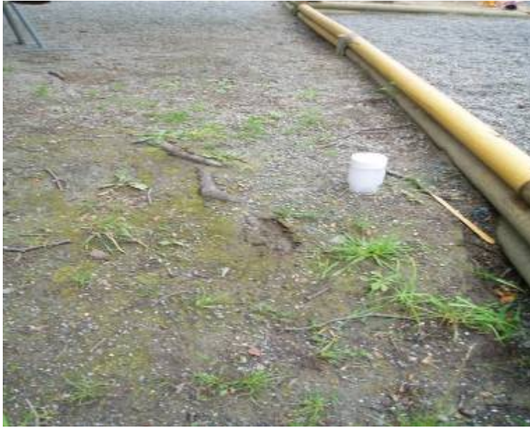
Figur 4.2.2 Lokalitet for prøvepunkt (1.4) med høyt innhold av B(a)P (0,8 mg/kg).
