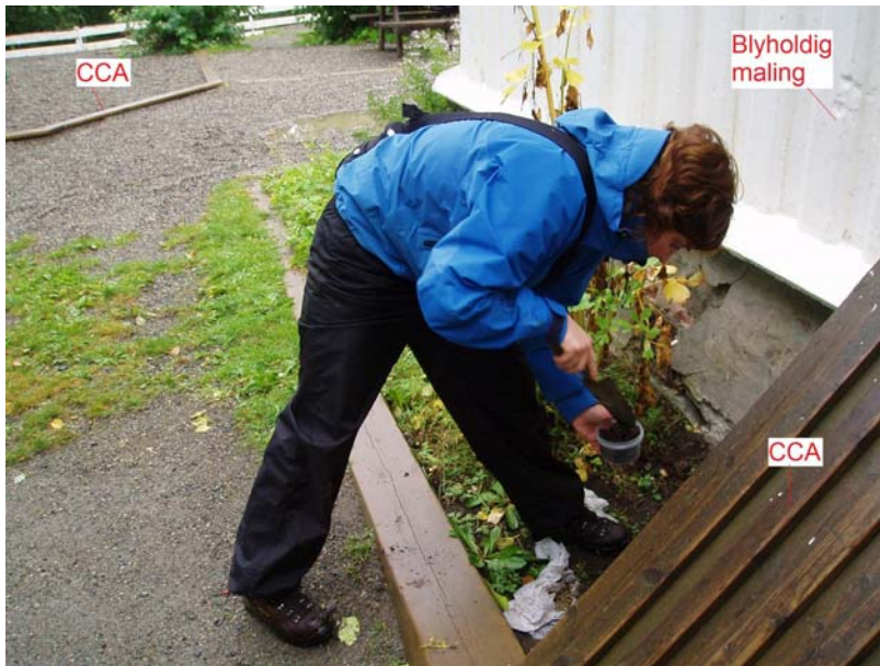
Figur 4.10.2 Lokalitet for prøvepunkt (9.9) med høyt innhold av bly (265 mg/kg). I tillegg vises trevirke med CCA og hvit maling med bly.
