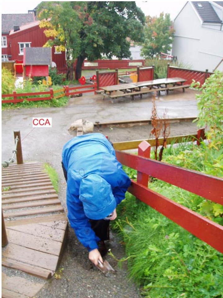
Figur 4.4.1 Stolpe som er impregnert med CCA.
