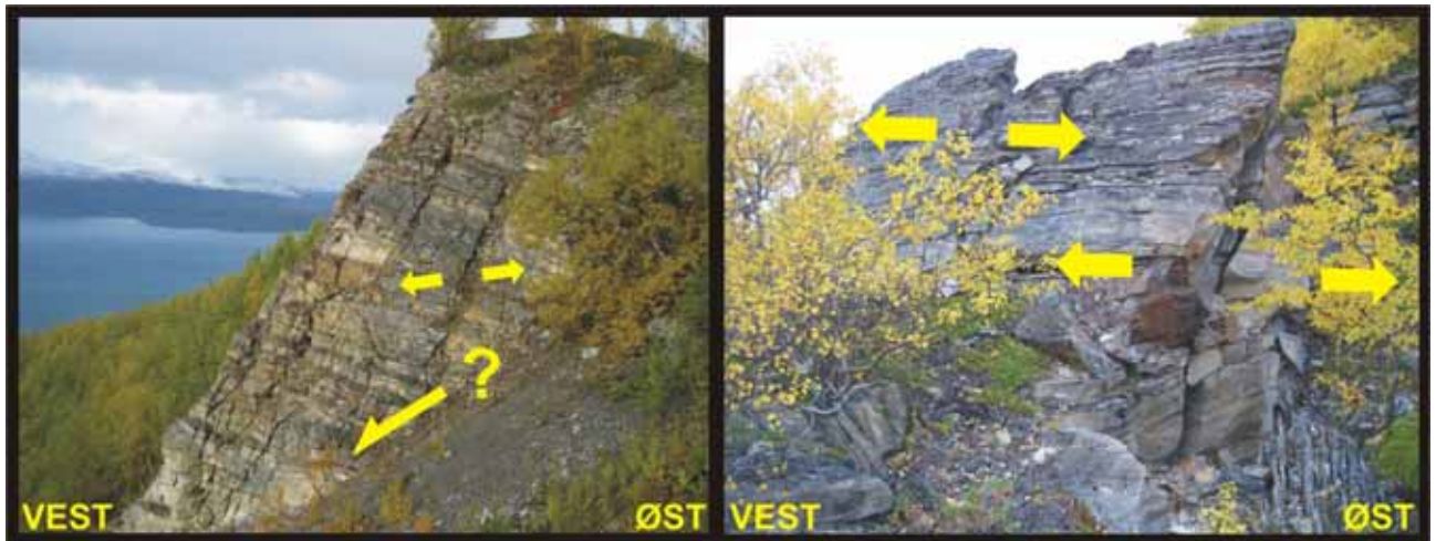
Figur 28. Steiltstående sprekker som er observert i den nedre del av Indre Nordnes. Det er antatt at fjellpartiet beveger seg på et lavvinkla skjærplan.
