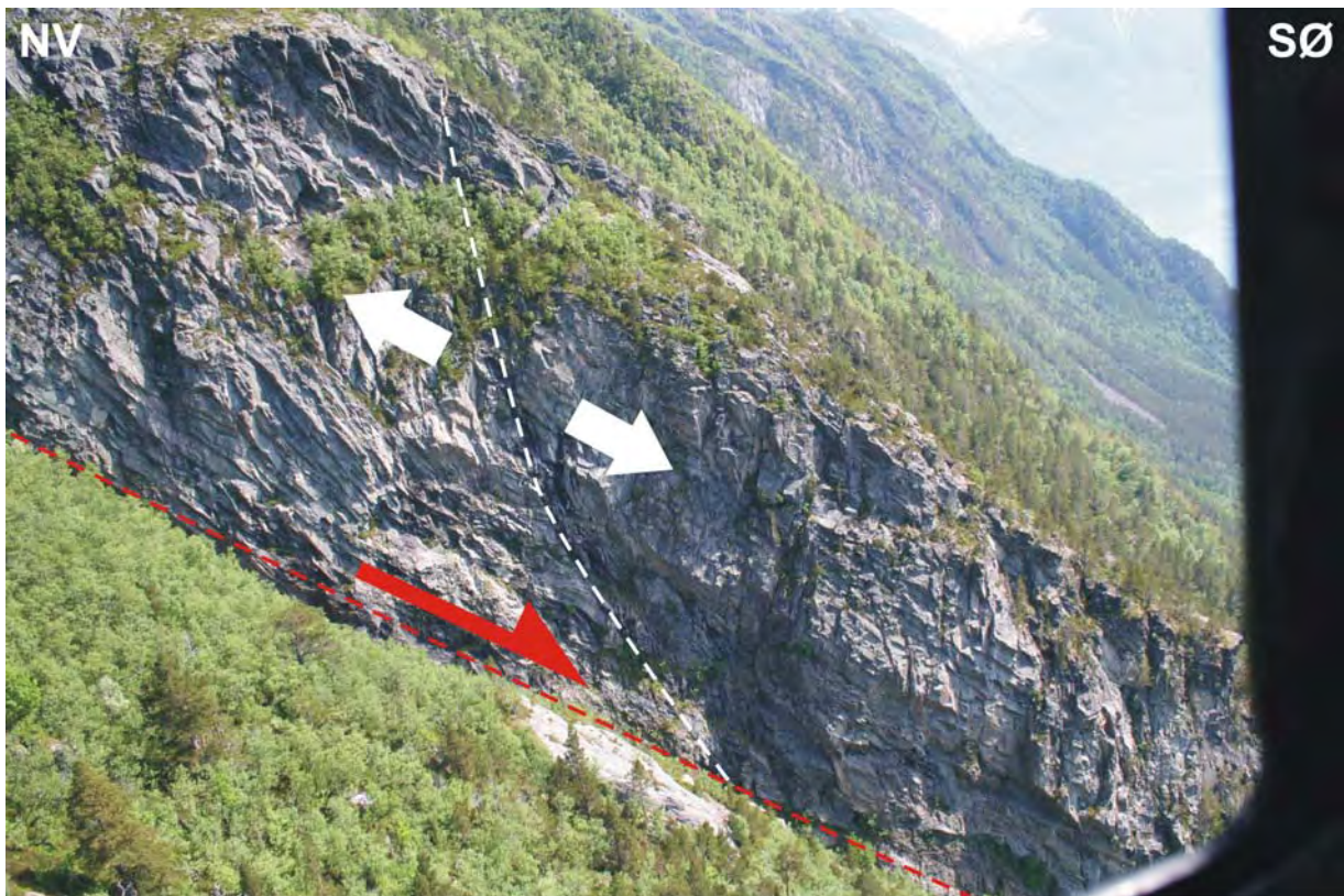
Figur 48: Bilde av lokalitet 21 som viser et velutviklet lavvinklet glideplan med en del sprekker i blokken som ligger oppå. De steiltstående sprekkene har begrenset åpning (noen få titalls centimeter) og har ikke strekt seg ned til glideplanet slik at blokken kan løsne.
