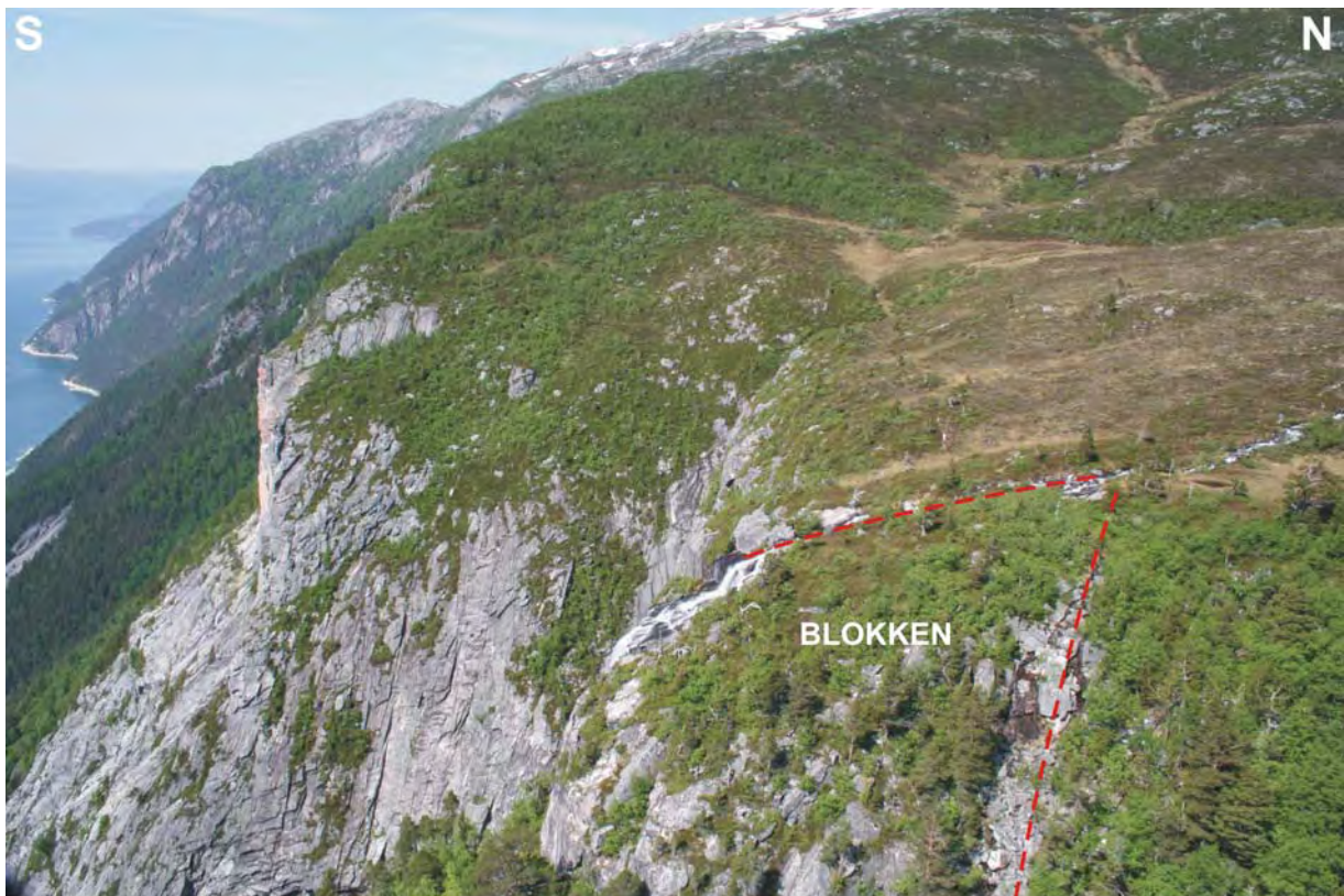
Figur 47: Bilde av lokalitet 20 hvor en baksprekk avgrenser en blokk med begrenset volum. Flere sprekker kan være tilstede og området bør undersøkes videre (men vil ha relativt lav prioritet).
