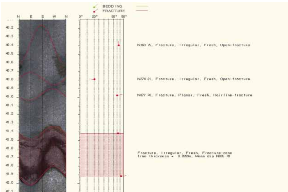
Figur 4: Eksempel på opptak og analyse. Enkeltstående sprekker er tilordnet sinusfunksjon og fallretning og vinkel beregnet. Pilhodet angir individuelle sprekkers fall mens halen viser fallretning (nord opp). Ved større åpne sprekker er topp og bunn digitalisert og sann åpning på sprekkenes er beregnet (nederst på bildet – fracture zone).
