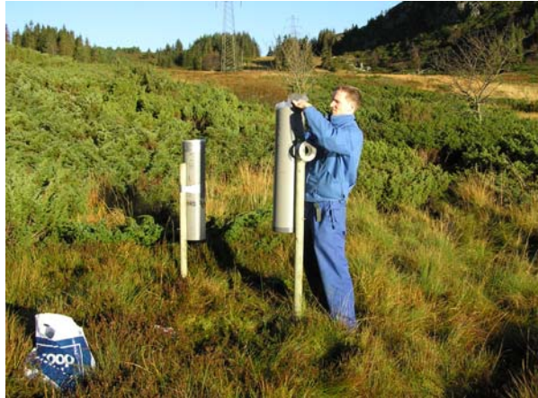
Figur 3. Montering av nedbørssamlere. Plastposer á ca. 10 L ble montert i store plastrør. Foto: H.Bjrdal
