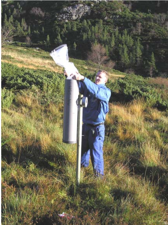
Figur 3. Montering av nedbørssamlere. Plastposer á ca. 10 L ble montert i store plastrør. Foto: H.Bjrdal
