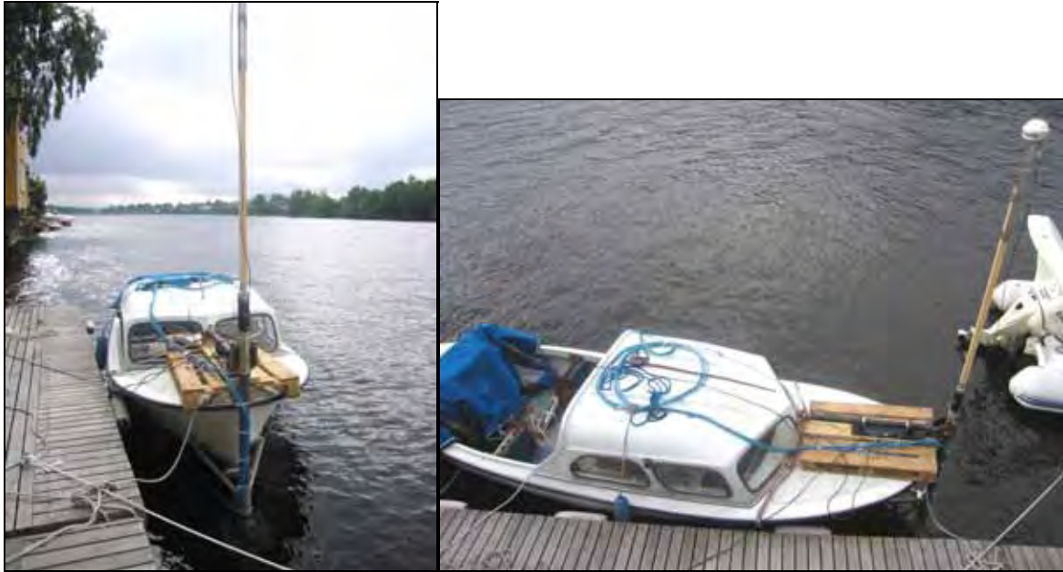
Fig. 3. Sonaren montert i baugen på båten som ble brukt til undersøkelsene.
