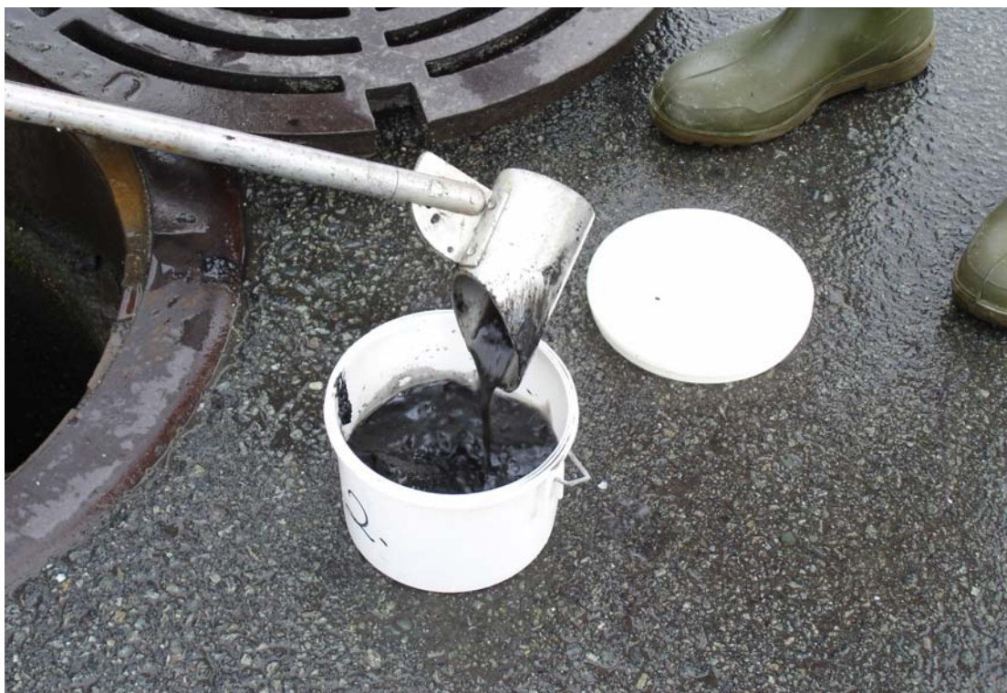
Figur 3 Prøvetakingsutstyr (aluminiumsstang med koppformet øse) og plastbøtte for prøvemateriale. Selve aluminiumstangen er ca 2 m lang.
