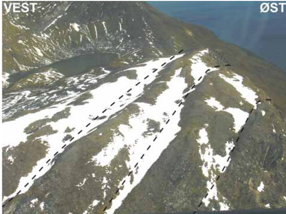
Figur 35. Sekundær sprekker på Ragnhildurtind som ligger på tvers av de store ekstensjonssprekkene. De viser en kombinert sideveis og ekstensjonsbevegelse og tar sannsynligvis tar opp det meste av bevegelsen i oppsprekkingene mellom de store ekstensjonssprekkene.
