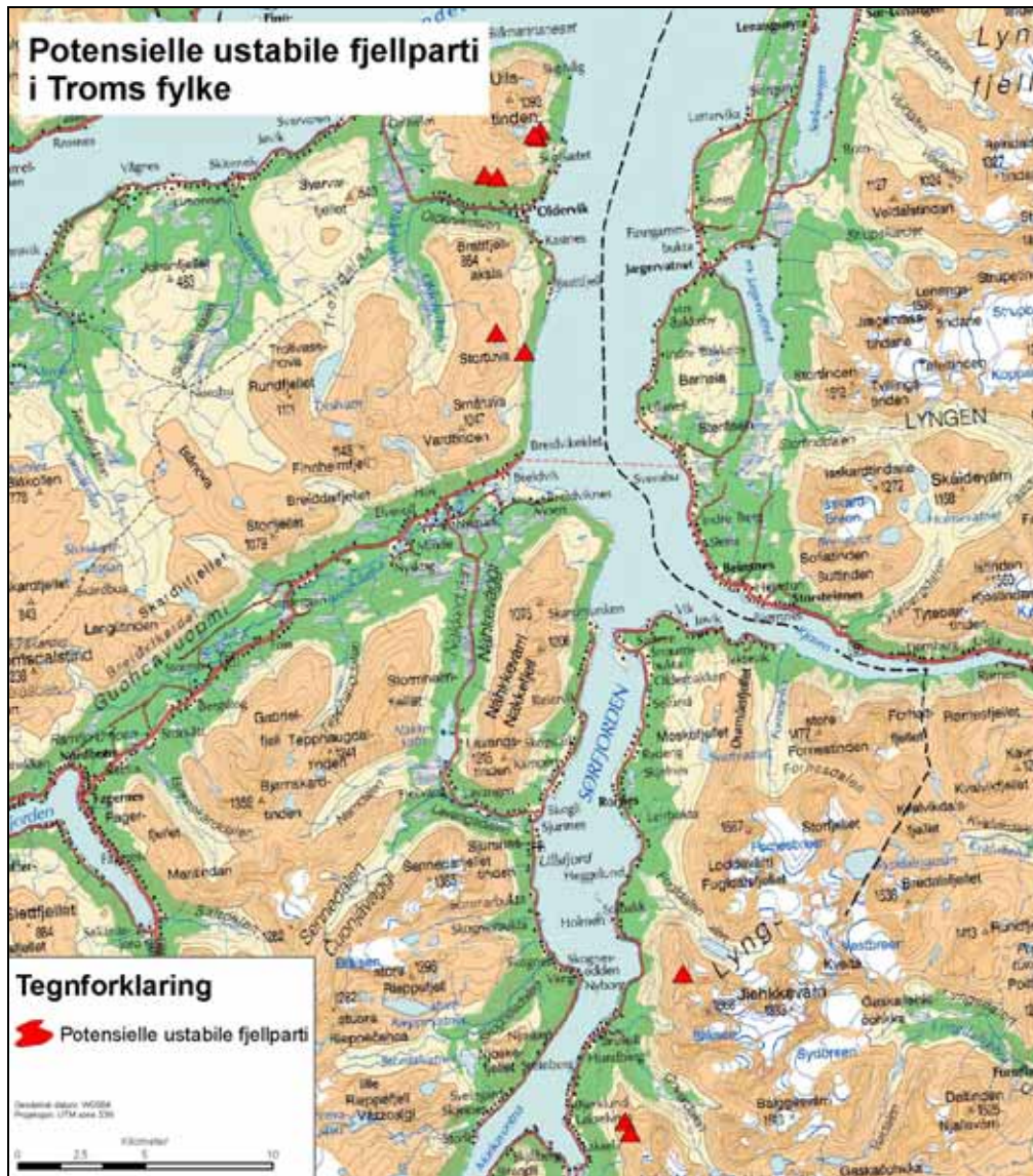
Figur 32. Oversikt over ustabile fjellparti som er identifisert ved helikopter befaring i Sørfjorden.
