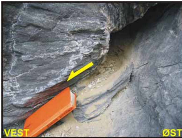
Figur 26. Noen tynne nedknuste soner (breksjer) som ligger langs fjordstupende strukturer med lav til moderat vinkel. Disse er observert ned skråningen fra de store ekstensjonsblokkene som er vist i Figur 25. Breksjene er klare bevis for nyere bevegelse og disse strukturene kan være årsaken til de store åpningene på de steilstående strukturene.
