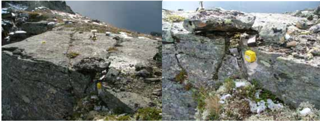
Figur 4. Venstre foto: To sjokk loggere (gul boks) på sida av en aktiv sprekk på Nordnesfjellet. GPS antennen ses montert på GPS målepunktet på samme fjellblokk. Høyre foto: Gul sjokk logger montert på siden av sprekk. Begge bilder er fra 14 september 2005.
