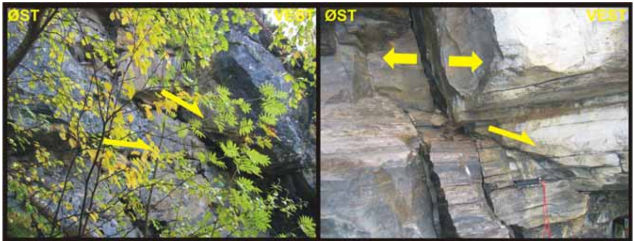
Figur 16. Strukturene sett på den sørlige delen av Nordnes. Venstre bilde: Lavvinklet skjærstruktur med flere centimeter bevegelse mot fjorden (ned mot høyre). Høyre bilde: Steiltstående strekkstrukturer som er utviklet pga skjærbevegelse langs lavvinklede glidesoner med bevegelser ned fjelsiden mot høyre.
