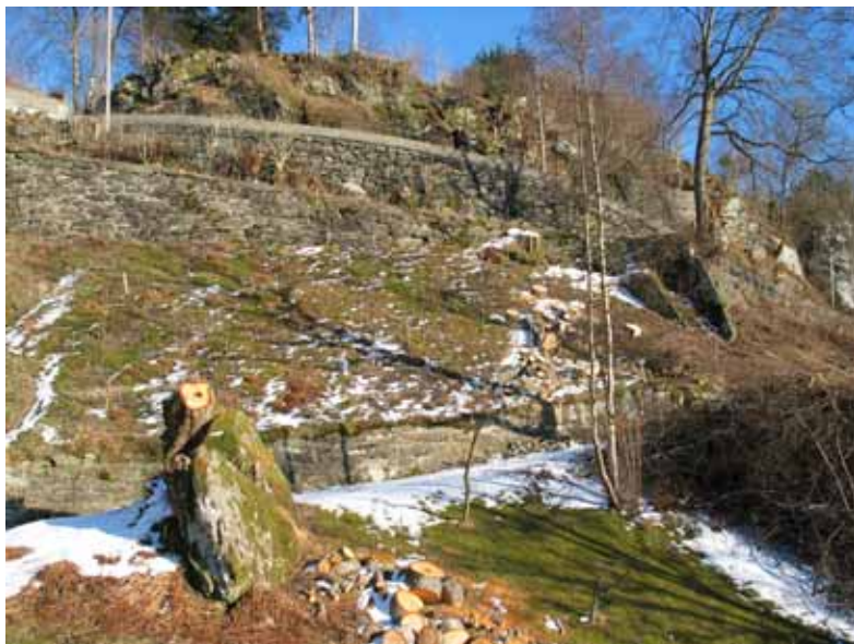
Foto: Fra Øvre Hopsnesvegen 7. Steinsprangblokk fra knausen i bakgrunnen ligger helt ned til boligene.
