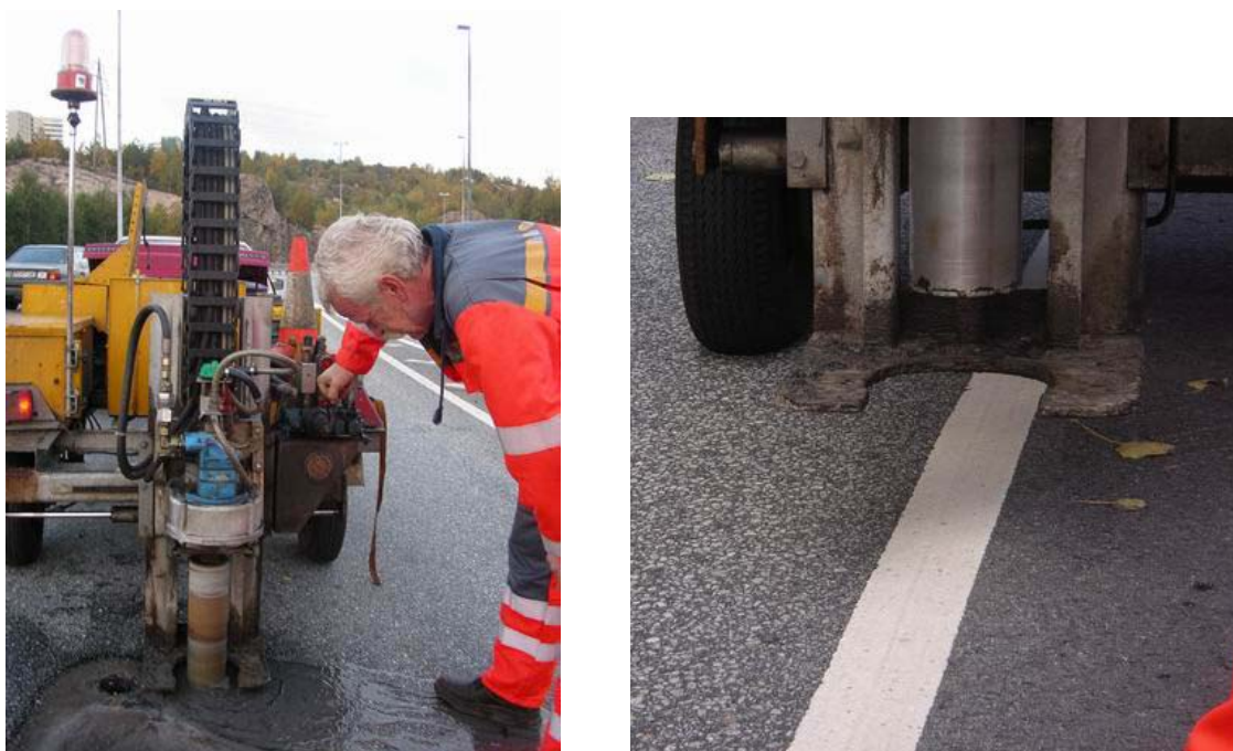
Figur 5. Prøvetaking av asfaltkjerne hhv. uten og med vegoppmerking.
