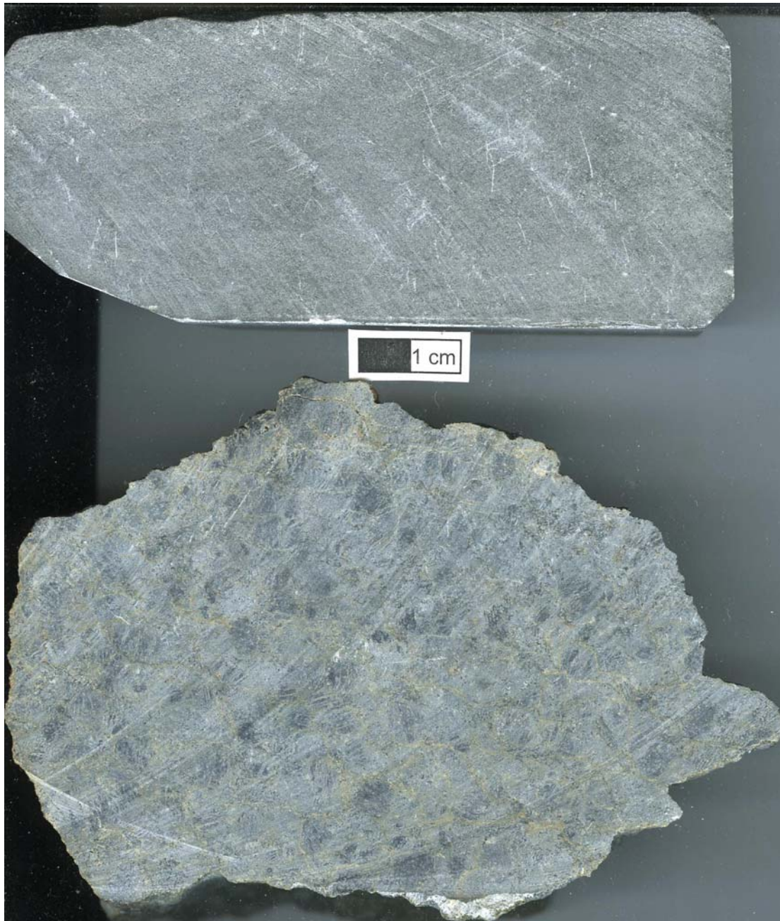
Fig. 4: Utsagde småprøver av kleberstein fra Tillermoen, finkornet tett type og "grovkornet" type fra Kleberberget med mørke krystaller av omvandlet pyroksen.
