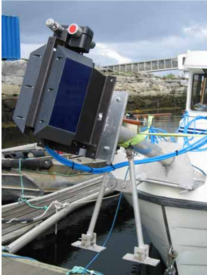
Figur 1. Sender/mottaker til interferometrisk sonar. Instrumentet med rød bunnflate øverst på senderen er et enkeltstråleekkolodd, og det ved siden av er lydhastighetsmåler.
