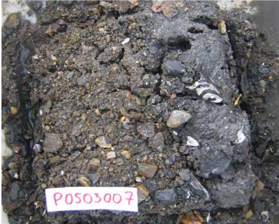
Figur 8. Boxcorerprøve P0503007 fra Bjørvika. Grusige sedimenter ved båtterminaler reflekterer propelleroppvirvling og fjerning av de mest finkornige sedimentfraksjonene.
