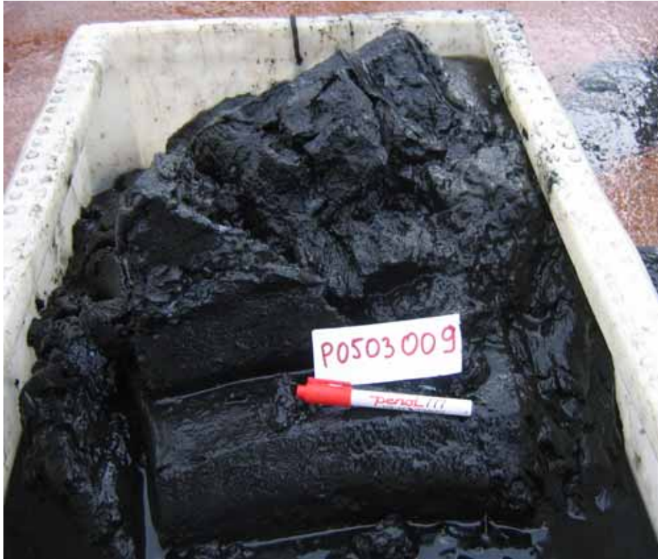
Figur 6. Prøve tatt med boxcorer (P0503009) utenfor Bjørvika. Finkornige, veldig bløte sedimenter inneholder mye organisk materiale og lukter sterkt av H_2S .
