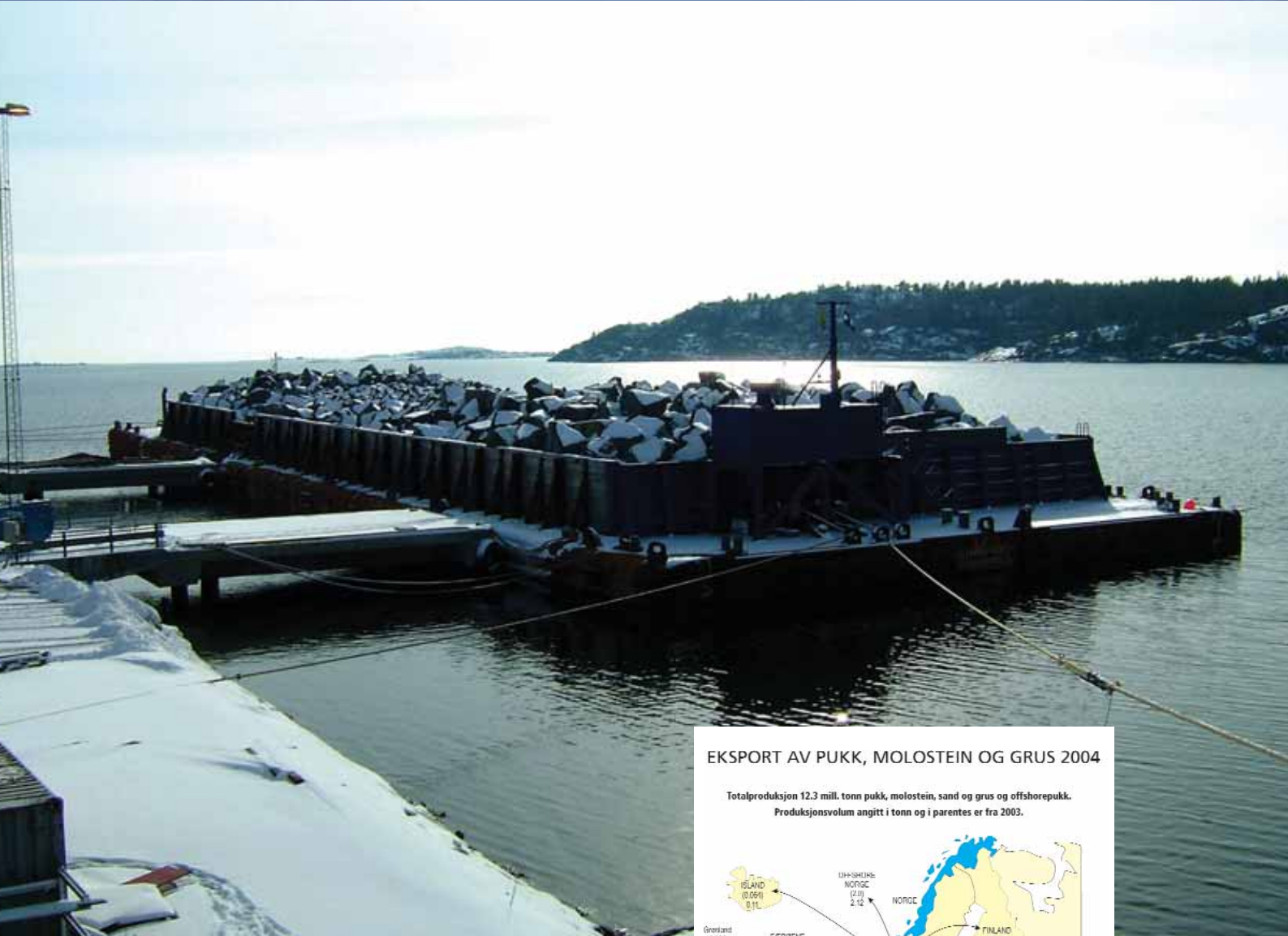
Svartbukta, Larvik. Stema shipping A/S. Kystsikringsstein-molostein i lekter til England med ca 20 000 tonn larvikitt. Foto: P.R.Neeb
