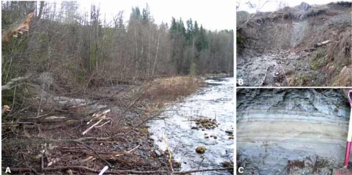
Figur 8: A) Skråningen ved Lauvlimoen nedstrøms Nustedfossen i et elveyttersving langs Stjørdalselva. Den slake, nederste del av skråningen dekkes i varierende grad av vann ved høyere vannstand/vannføring i elven. Det bygges ut sedimentløper nedenfor skråningen på grunn av erosjon høyere oppe på skrenten. B) Lokalitet L51b ved utglidning øverst på skrenten umiddelbart under vei. Utglidningen involverer 4 m sand og grus i toppen over hav- og fjordavsetninger. C) Sandlag i de finkornige hav- og fjordavsetninger.
