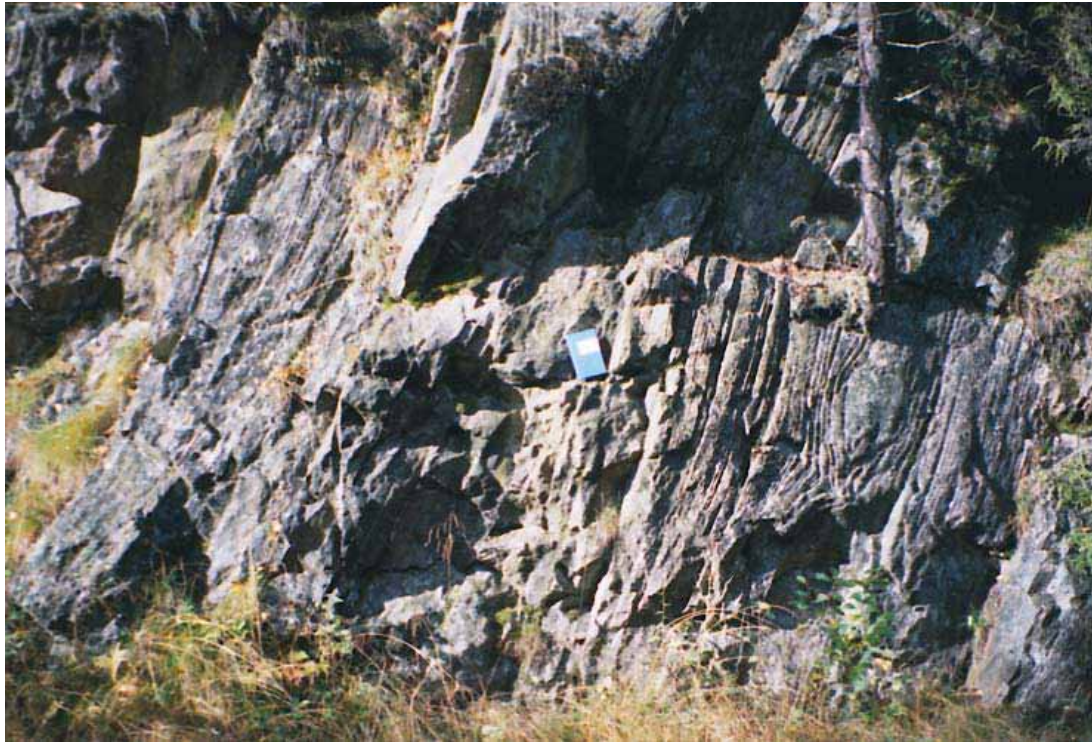
Figur 5. Velfoliert granat-biotittgneis med en god mylonittisk planstruktur. Uregelmessigheter i lagdelingen i den høyre delen skyldes linser av amfibolitt. Lokaltet tett ved veien 300 m vestsydvest for Fjellmyr.
