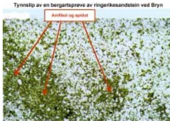
Figur 5–11: Tynnslip laget av bergartsprøve av ringerikesandstein ved Bryn (Nordstrand, 2001).
