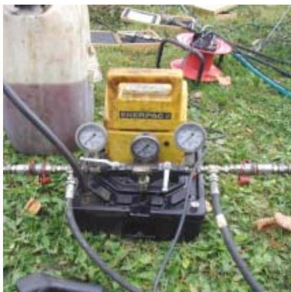
Figure 2–8: En liten høytrykkspumpe for trykksetting med lettflytende olje av øvre og nedre pakning på dobbeltmansjett. I forgrunnen: To utganger for digital måling av trykk i pakningene.
