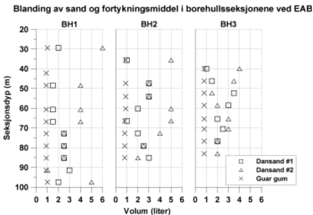
Figur 4-19: Innhold av de to sandfraksjonene, Dansand 1 og 2, og fortykningsmiddelet guar gum injisert i de enkelte seksjonene i borehull 1, 2 og 3 ved EAB.
