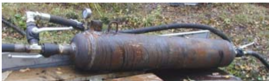
Figur 2–14: Høytrykkstank for lagring av injeksjonsmasse ved hydraulisk trykking med injeksjon av sand.
