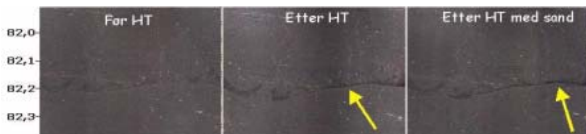
Figur 5–34: Bildene, tatt med optisk televiever, viser et utsnitt av borehull 2 før hydraulisk trykking (venstre), etter hydraulisk trykking med bare vann (midten) og etter hydraulisk trykking med vann iblandet fortykningsmiddel og kvartssand (høyre). Sprekk 82,2 meter under topp rør er tydelig mer åpen etter hydraulisk trykking med både vann og -sand.
