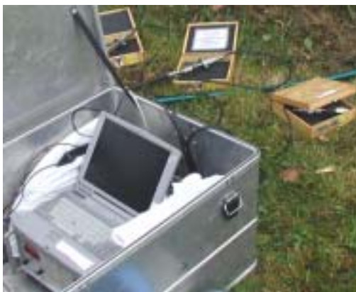
Figure 2–12: Venstre: Kyowa trykkløpere er tilkoblet en målebro som igjen er koblet til en datalogger. Data lastes ned fra loggeren via PC. Høyre: Trykkløper for måling av vann- og pakningstrykk.
