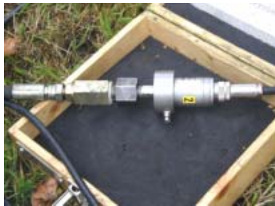
Figure 2–12: Venstre: Kyowa trykkløpere er tilkoblet en målebro som igjen er koblet til en datalogger. Data lastes ned fra loggeren via PC. Høyre: Trykkløper for måling av vann- og pakningstrykk.
