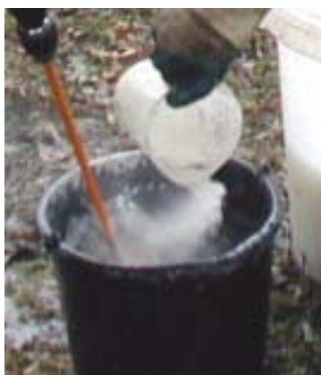
Figur 4–17: Blanding av vann, guar gum og sand. Påfylling av injeksjonsblanding på høytrykkstanken er vist i høyre i bakkant.
