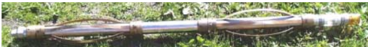
Figure 2–17: Sonde med sentreringsfjærer for logging med optisk televiewer. Videoenhet til høyre.
