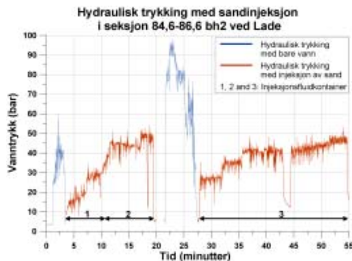
Figur 5-7: Trykk-tid diagram for hydraulisk trykking med vann og injeksjon av sand i borehull 2 ved Lade. Beholder med sandblanding nummer 1, 2 og 3 ble injisert ved de angitte tidspunkt.
