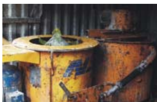
Figur 4-6: Blander, beholder og injeksjonspumpe
