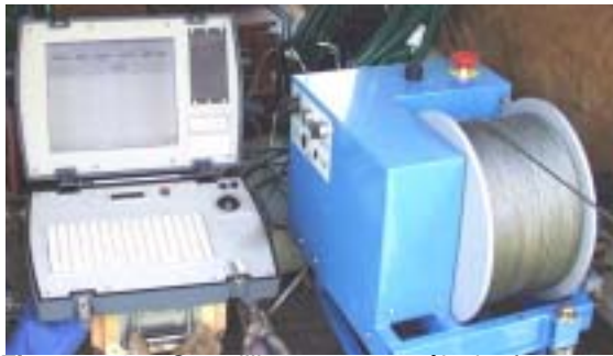
Figure 2-19: Oppstilling av pc og stålvaier for logging med optisk televiwer.
