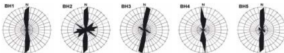
Figur 5–35: Sprekkeroser fra borehull 1-5 ved Bryn. Fallvinkelen for hovedsprekeretningen varierer mellom 40-60° mot vest.
