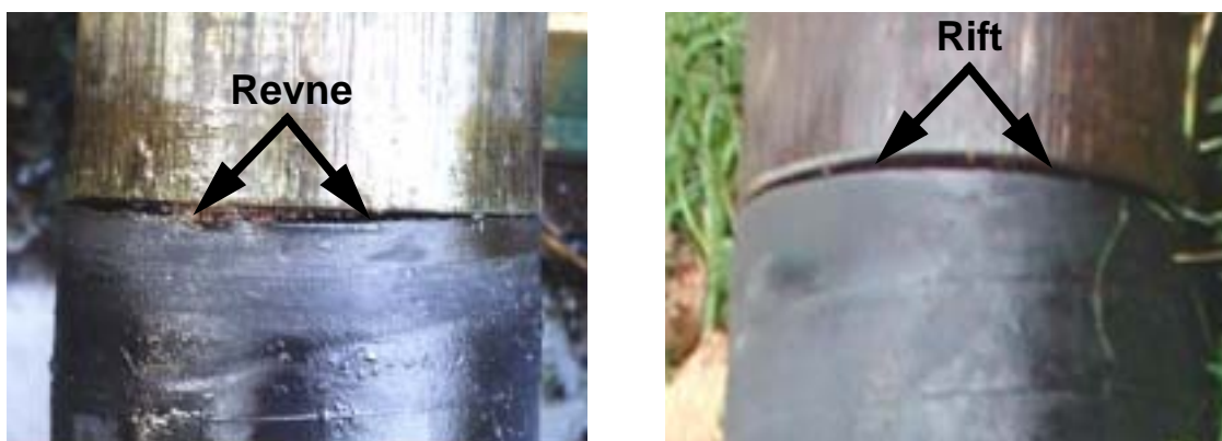
Figur 5–93: Revnet nedre pakningselement fra hydraulisk trykking med bare vann i borehull 2 ved Bryn (venstre), og en rift på nedre pakningselementet fra hydraulisk trykking med injeksjon av sand i borehull 2 ved EAB (høyre).
