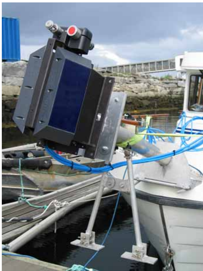
Figur 2. Sendar/mottakar til interferometrisk sonar. Instrumentet med raud botnflate fremst på sendaren er eit enkeltstråleekkolodd, og det ved sida av er lydfartsmålar.
