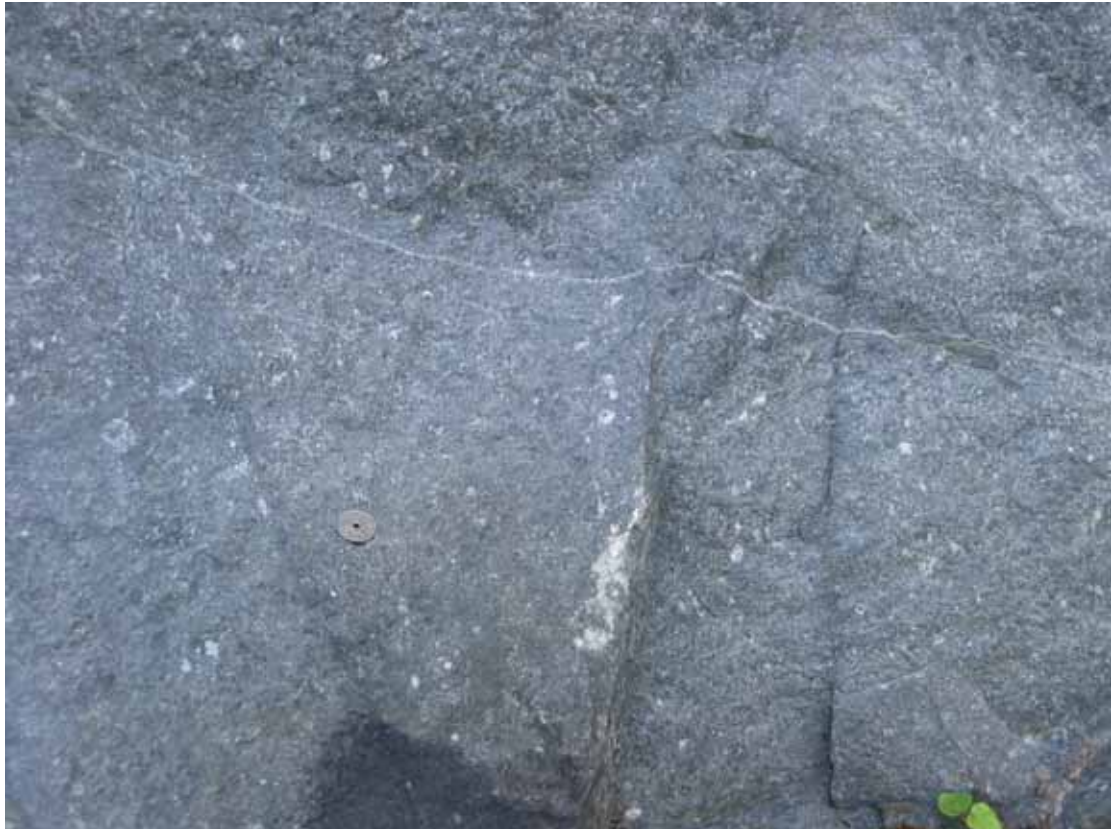
Figur 5. Finkornet omdannet vulkanitt med antatt potensiale for høy pukkkvalitet.
