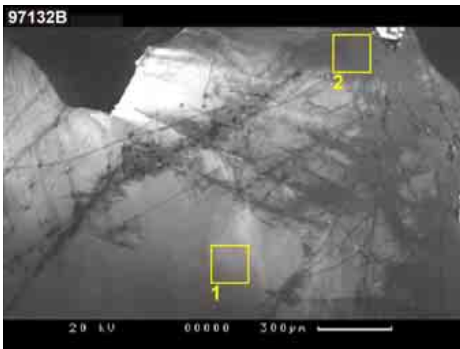
Fig. 8. SEM-CL bilde av analysepunktene i slip B fra prøve 97132. Den primære kvartsen med punkt 1 (lys grå) har blitt fortrent av sekundær kvarts (mørk grå) langs et system av sprekker. Punkt 2 ligger i sekundær kvarts. Analyseverdiene er gitt i Tabell 2.
