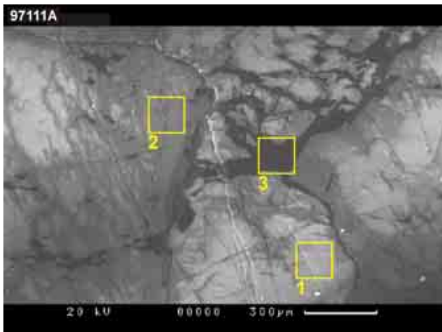
Fig. 10. SEM-CL bilde av analysepunktene i slip A fra prøve 97111. Den primære kvartsen (lys grå) med punkt 1 er sterkt fortrenget av tidlig sekundær kvarts (lys grå) med punkt 2, og sen sekundær kvarts (mørkere grå t.h. for punkt 2). Alle disse fasene gjennomsettes av sprekkefyllinger med tertiær kvarts (svart) hvor punkt 3 er analysert. Analyseverdiene er gitt i Tabell 2.
