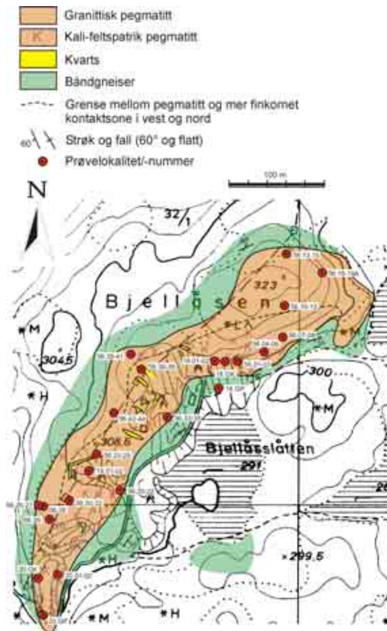
Fig. 1. Detaljkart av pegmatitten på Bjellåsen som viser fordelingen av analyseprøver og den gradvise grensen mellom ekstremt grovkornet pegmatitt i SØ og mer finkornet pegmatittisk granitt i nordvest. Kartet er hentet fra Søvegjarto (2001c).
