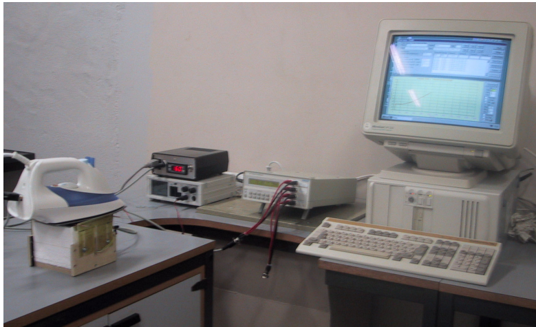
Figur 25: Apparatur for måling av varmeledningsevne.
