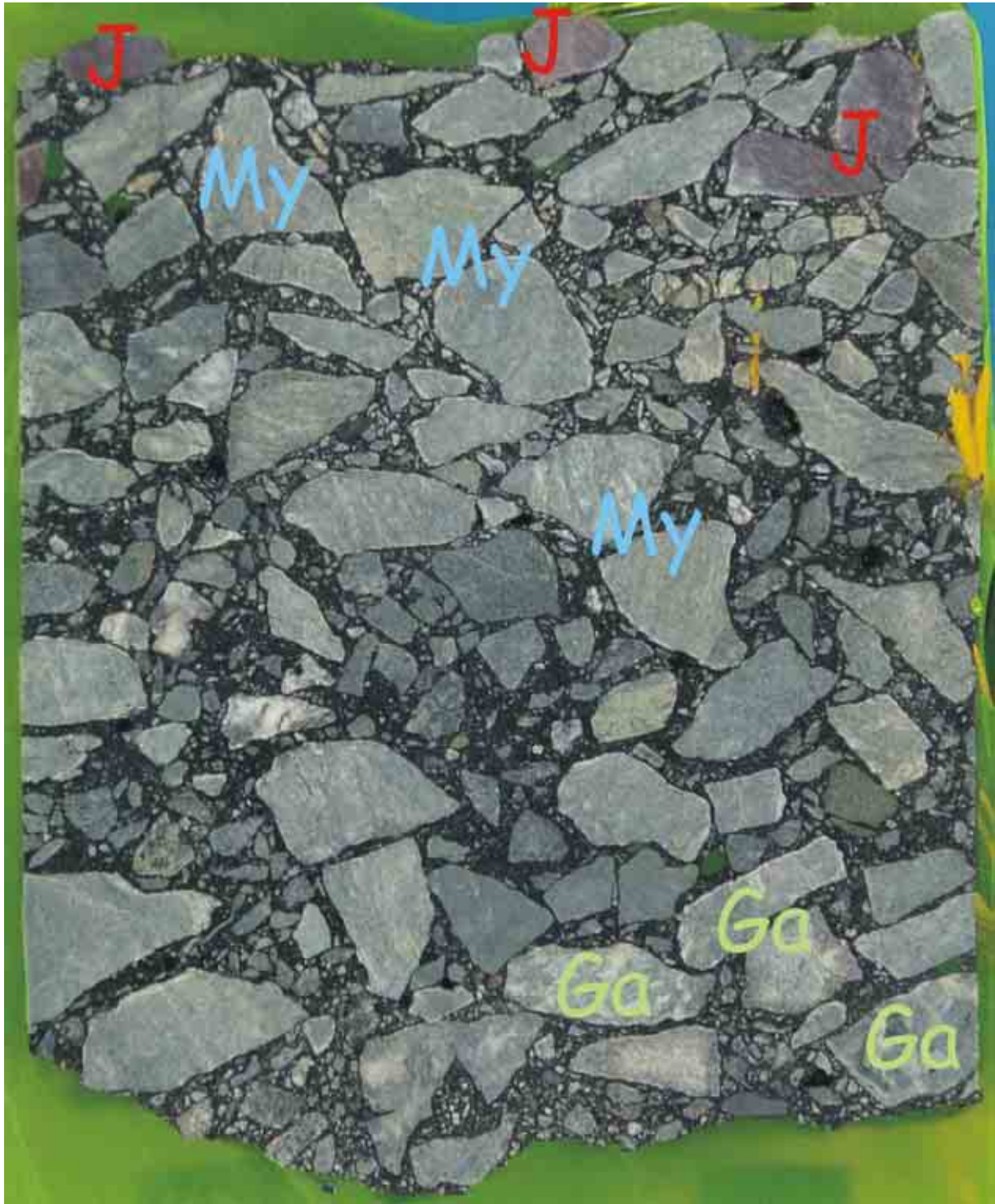
Figur 30. Planslip av asfaltkjerne fra Rosendal, vestgående felt. Merk rødlige jaspis (J) i toppen av kjernen i en ellers mylonitt (My) dominert resept. Enkelte få korn med gabbro (Ga), tilkjennegitt med sjatteringsmønster, i bunn av kjernen. Diameter på kjernen er 75mm.
