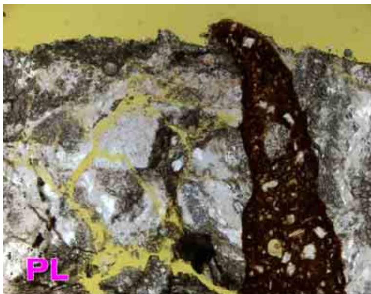
Figur 40a) Detalj av slitasje av et mylonittkorn fra Omkjøringsveien, i planlys (PL). Bildebredde er 1.49mm. Bindemiddelet, sees som en mørkebrun søyle, gir heft til et fullstendig oppsmuldret mylonittkorn.
