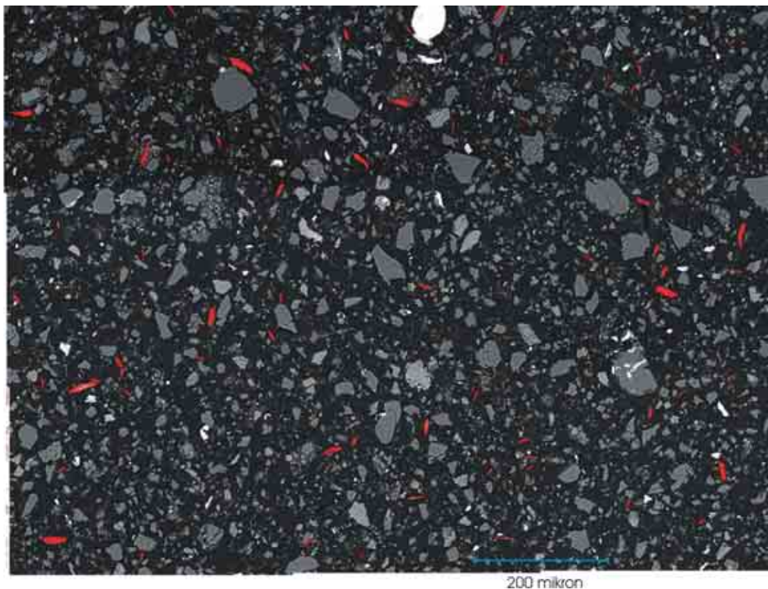
Figur 8. Backscatter bilder av filtrert støv produsert med Trøger fra Omkjøringsveien. Korn med lengde : bredde >3 er farget rødt (0.71 volum %).
