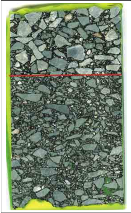
Figur 3. Planslip fra asfaltkjerne fra Elgeseter nylagt i 2003. To markerte lag er synlig i planlys. Diameter på kjernen er 75mm.
