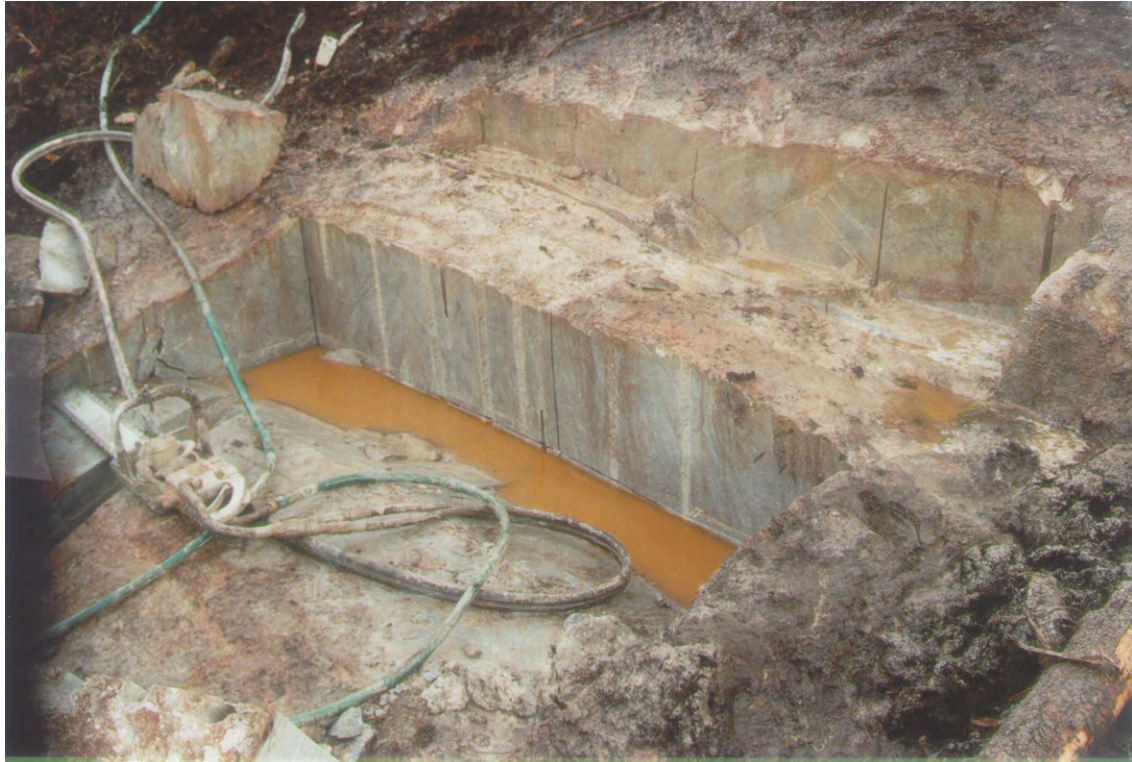
Fig. 1: Uttak av kleberblokk med motorsag på Brians kuppe.
