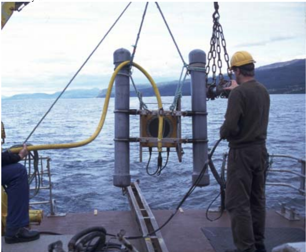
Figur 14: Seismiske undersøkelser med NGUs fartøy "Seisma".
