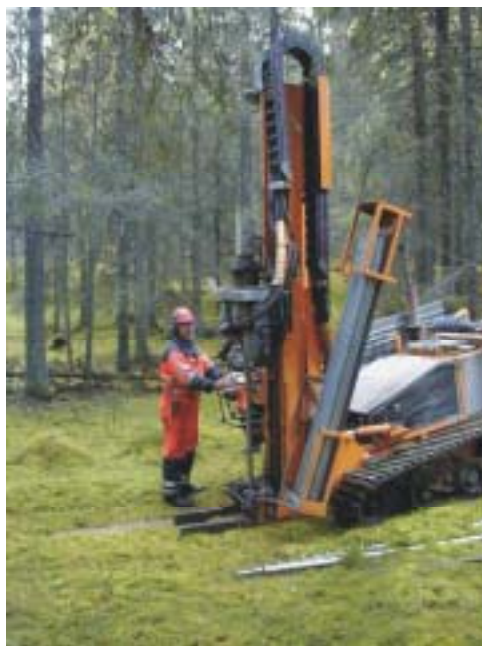
Figur 1. Sondering med beltegående borerigg.
