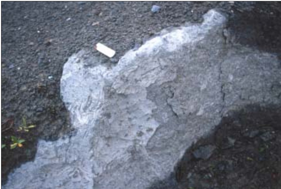
Figur 20 Begynnende avskalling av forvitret overflate og etterfølgende gropdannelse i kleberstein i nordlige del av Bubakkforekomsten. Avskallingen gjør at detaljene i huggesporene forsvinner.
