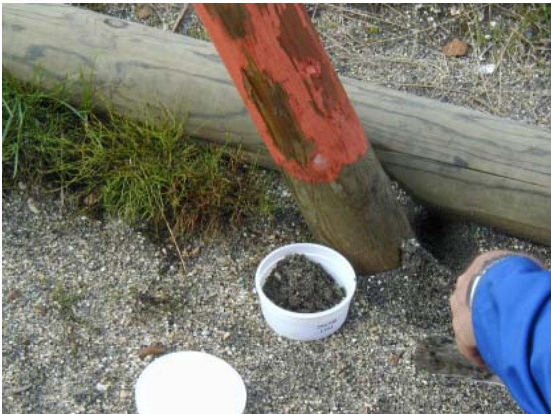
Figur 3. Hvis de trykkimpregnerte stokkene skal oljebeises og ikke fjernes, bør hele stokken behandles. Her vil stokken fortsatt forurense sanden.
