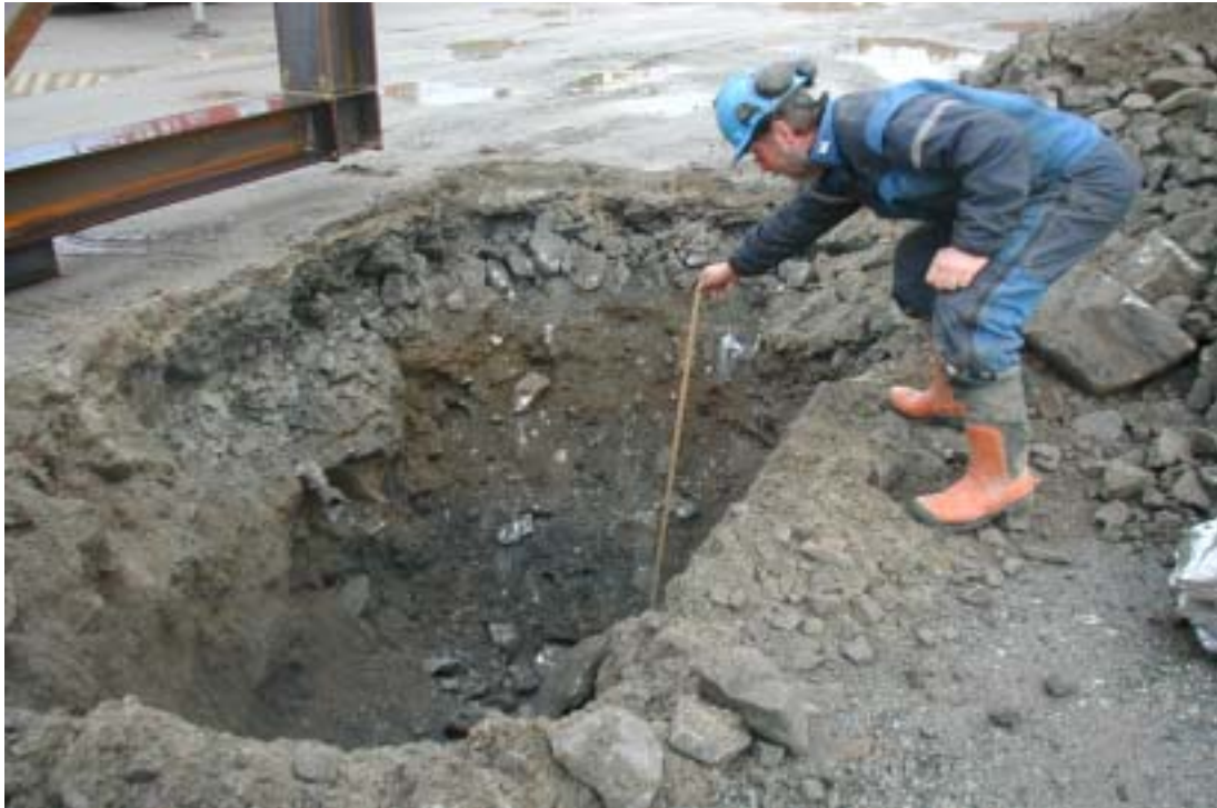
Figur 3 Tilkjøpte masser og stedegne marine sedimenter er de dominerende massetyper på det undersøkte området.
