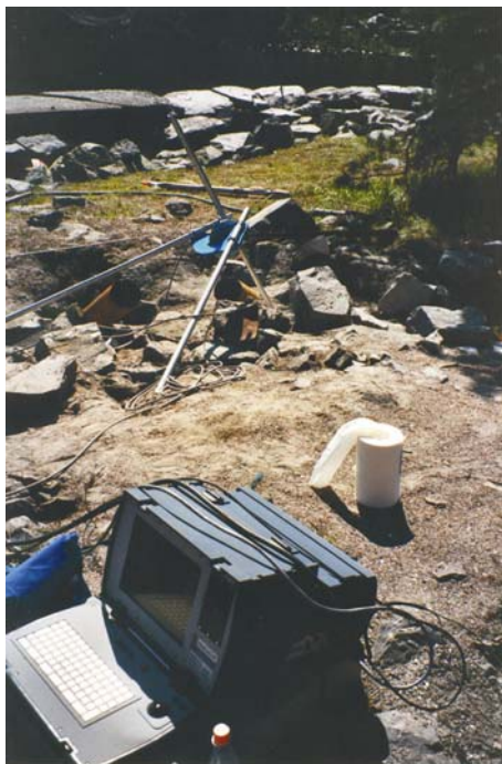
Figur 2. OPTV loggeutstyr. Loggeenhet (til venstre) og klart for logging (B). (Foto, Lars Larsen)
