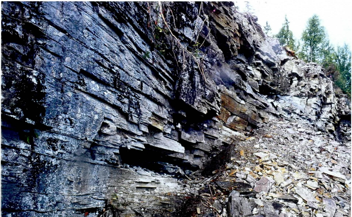
Figur 4 b: Parti i det øvre bruddet, nedenfor anleggsveien vist i figur 4 a. Bildet viser velutviklet planskiffrighet på 1-3 cm skala.
