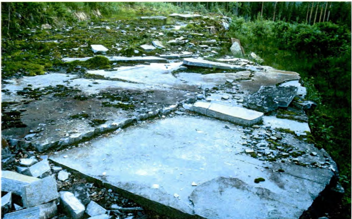
Figur 22: Kløvflater i den nordlige delen av Haukeliforekomsten. Legg merke til den relativt store hyppigheten av sprekker og tykkelsen på hellene. Bilde tatt mot nordvest.
