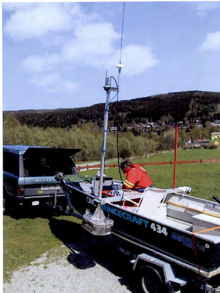
Foto 1. GPS-antenne montert over ekkoloddets sender/mottaker
