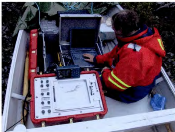
Foto 2. Plassering ombord av ekkolodd, GPS-mottaker og PC for operasjon av samlet målesystem
