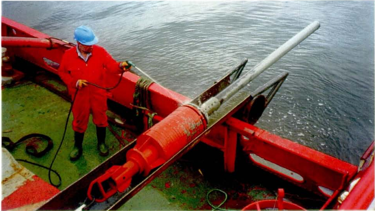
FIGUR 1-3: Gravitasjonsprøvetakeren rengjøres etter prøvetaking på en av de dype stasjonene i ytre havn. Det røde feltet som spyles er blyloddene som lastes på for å få nok vekt til å trenge ned i sjøbunnen.
