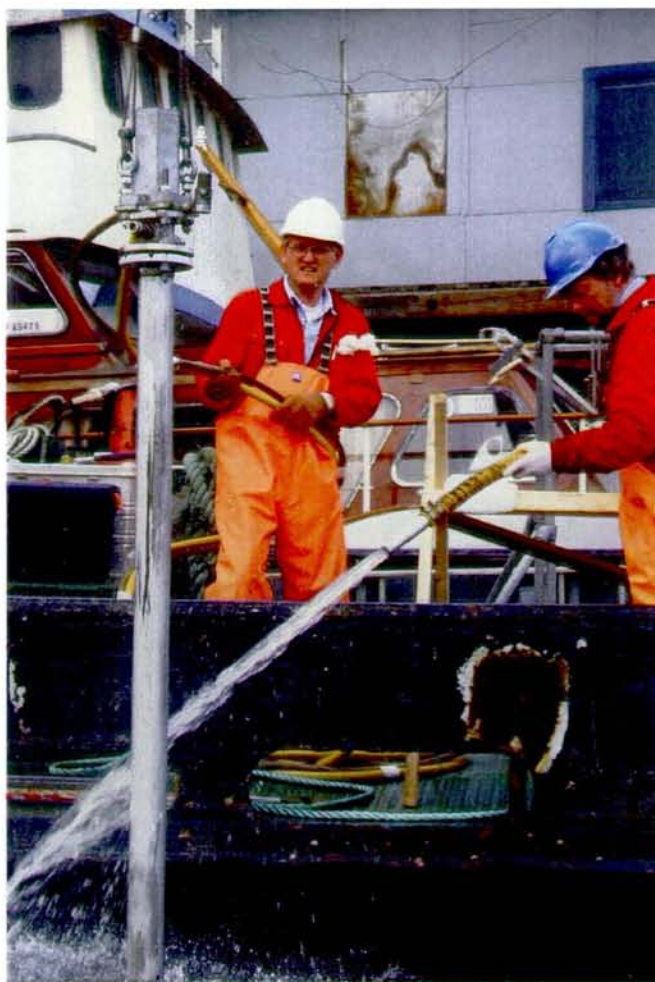
FIGUR 1-2: Bildet viser hevingen av vibrasjonsprøvetakeren etter vellykket prøvetaking i kanalen. Slammet som spyles av røret viser at prøvetakeren har vært dypt nede i bunnsedimentene.
