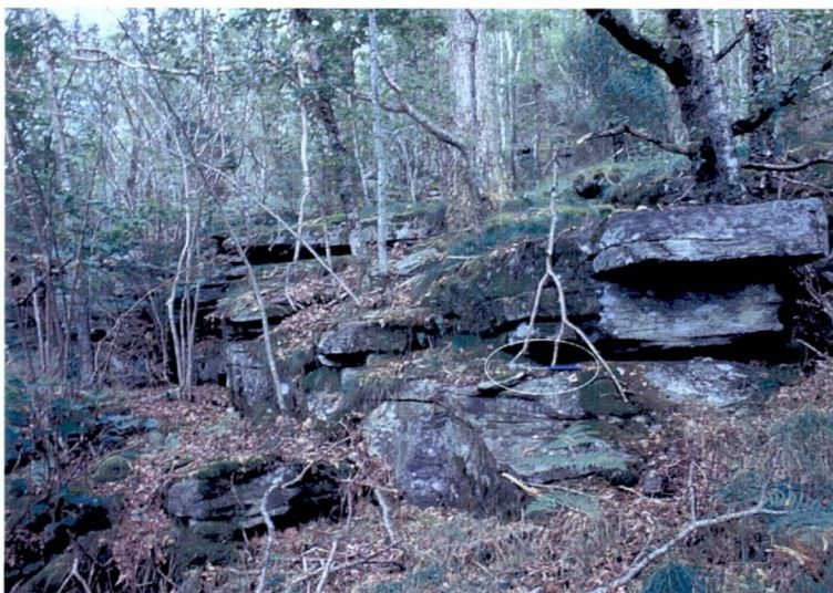
Figur 3 Lav benkning i granittisk gneis ved Løland. Merk at bergarten opptrer i mer eller mindre løse 'flak' som vil være lett å ta ut. Hammer for skala (i eliptisk felt).
