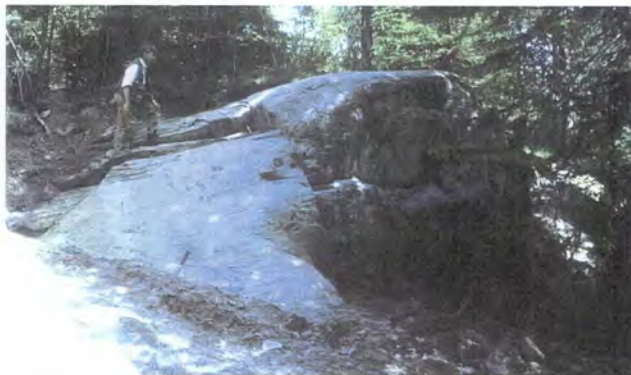
Figur 10 a, b: Skifersonen i veikanten ved Nesterud. Nærbildet viser en god gjennomgående skifrihet med 2-3 cm avstand mellom glimmerplanene.
