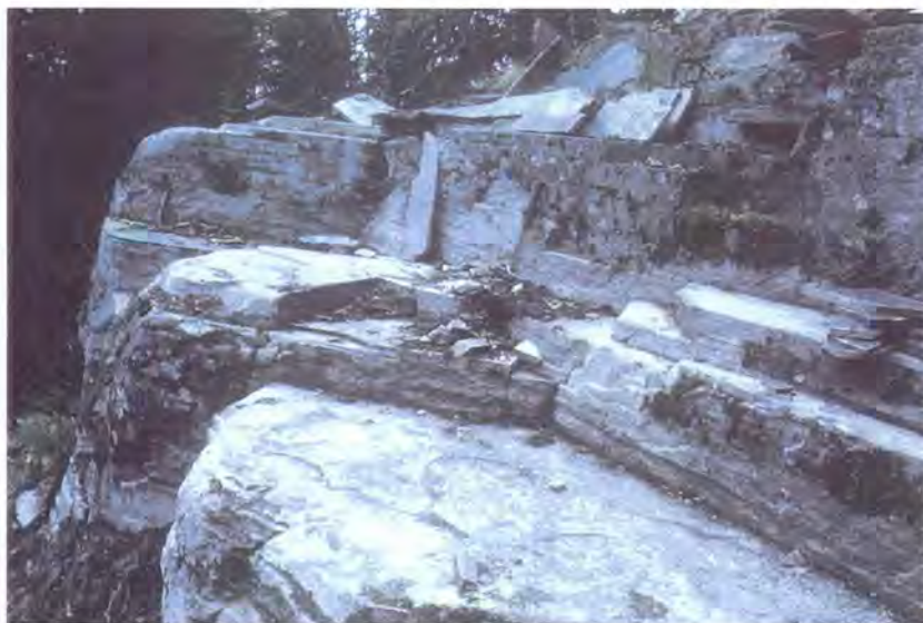
Figur 11: Skifersonen øst for Nesterud. Spaltbarheten er noe dårlig som vist ved ujevne spalteflater. Flatene er imidlertid plane.
