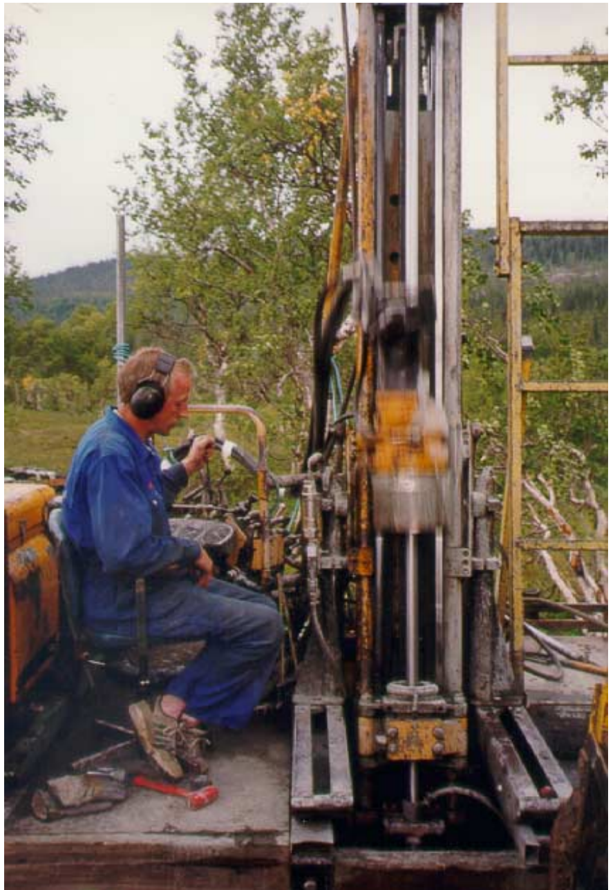
Ingeniør Geir Viken utfører diamantboring på malmpotensialene i Bleikvassli. Foto: Terje H. Bargel
