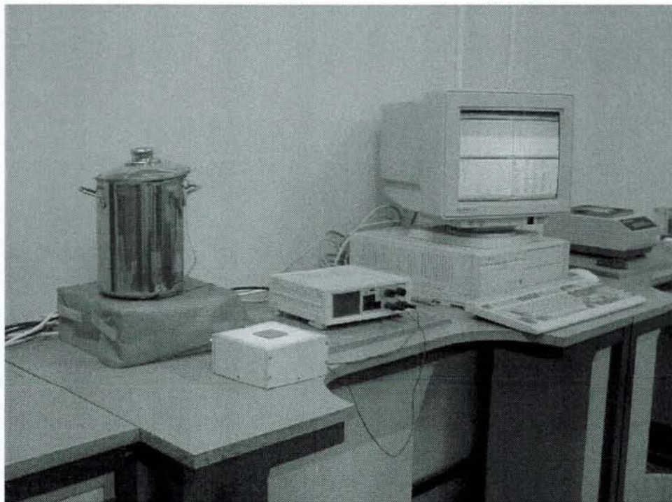
Figur 3. Foto av NGU's utstyr for måling av varmeledningsevner.
