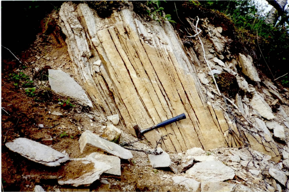
Figur 2 Prøvebruddet. Kalkspatmarmor med tilnærmet planparallell benkning.
