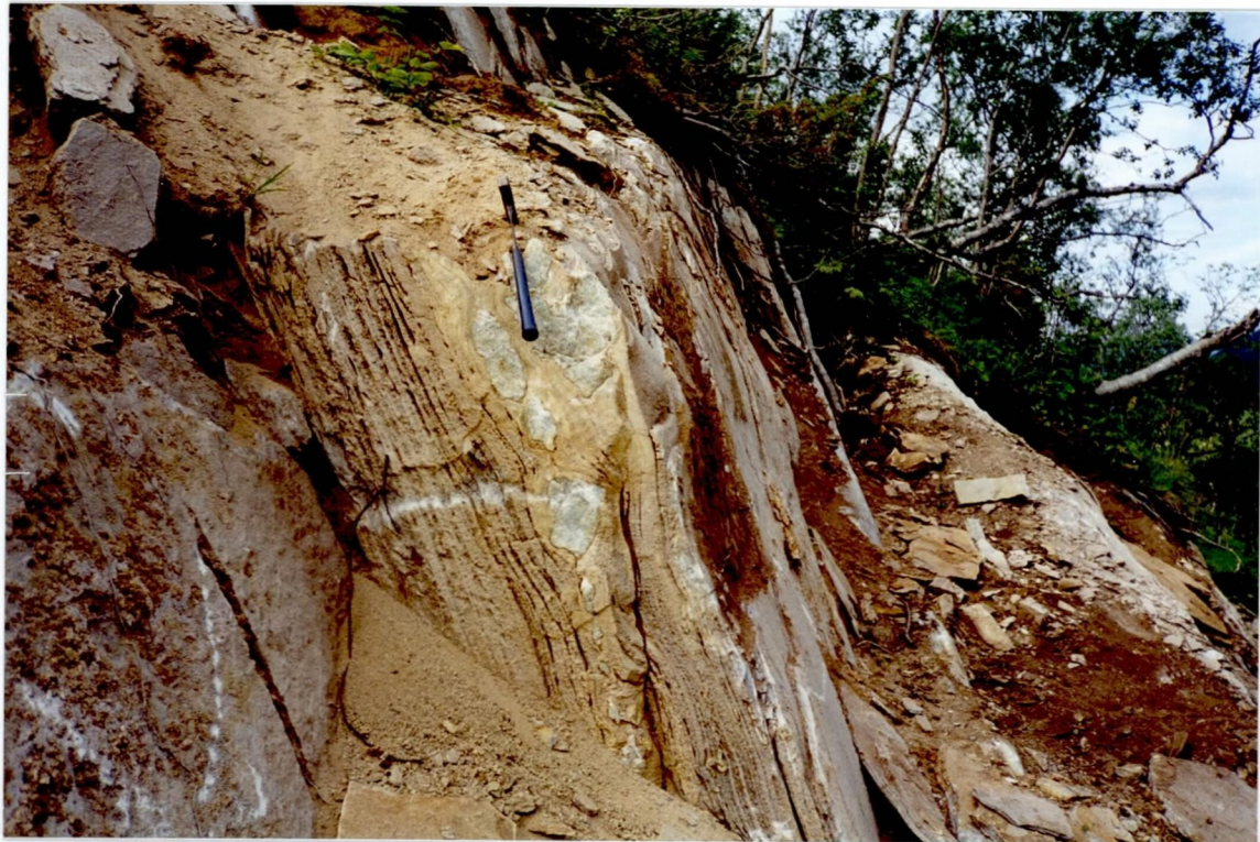
Figur 3 Prøvebruddet. Kalkspatmarmor med inneslutninger av hydrotermal kvarts.
