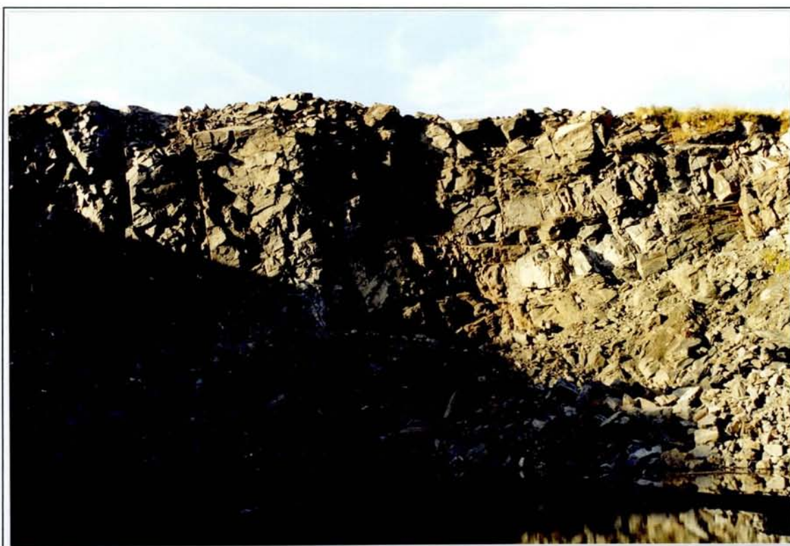
Figur 19. Grønnsteinen har flere uheldige trekk, og ett av disse er den store graden av oppsprekning. Fra steinbruddet (pukk) sørligst på lok. N10.
