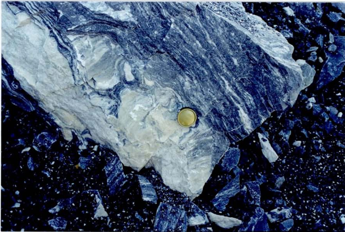
Figur 23. Laminert blågrå marmor med linser av sekundær hvit kalkspat. Lok. Røy-2, Huddingsvatnet.
